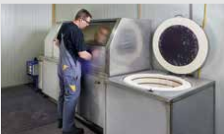
1. In der Ausblasstation wird der Filter in beide Richtungen ausgeblasen.
