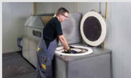
2. Im Abbrennofen wird der Russ im Filter abgebrannt.
