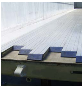
600 mm Muldenwandprofile machen den Trailer extrem robust. Fliegl bietet 6, 8 und 10 Millimeter starke Aluminium-Schubbodenprofile an sowie Heavy Duty und Stahlbodenvarianten.
