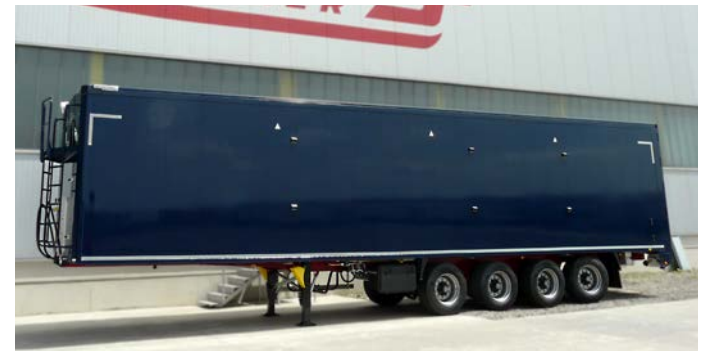
Scandic Modell in Vierachs-Ausführung mit verstärkter Rahmenkonstruktion für bis zu 54 Tonnen Zuggesamtgewicht.
