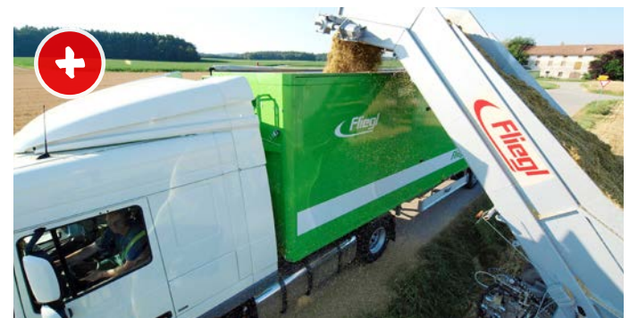
Auch auf dem Feld kommen Schubbodentrailer zum Einsatz. Der Fliegl Power Floor eignet sich für den Transport aller gängigen Materialien zur Befüllung von Biogasanlagen.
