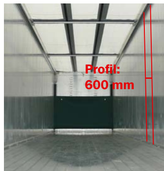
600 mm Muldenwandprofile machen den Trailer extrem robust. Fliegl bietet 6, 8 und 10 Millimeter starke Aluminium-Schubbodenprofile an sowie Heavy Duty und Stahlbodenvarianten.
