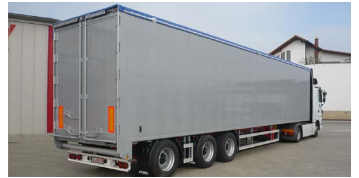
Scandic Modell mit verstärktem Rahmen, verlängertem Radstand und Nachlaufenkachse.
