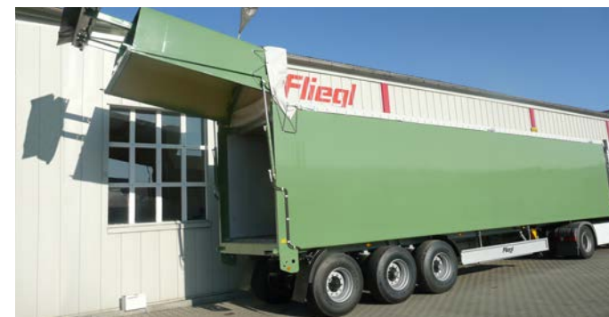
Power Floor mit hydraulischer Volumen-Heckklappe.
