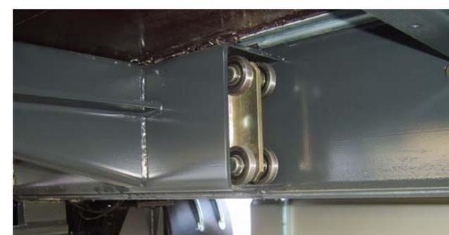
Roulements à rouleaux en tandem pour l'extension arrière
