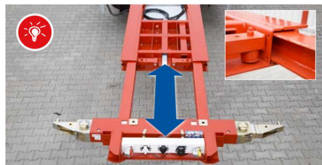
Extension avant à roulements à rouleaux et amortissement en caoutchouc pour améliorer la longévité et la manipulation.
