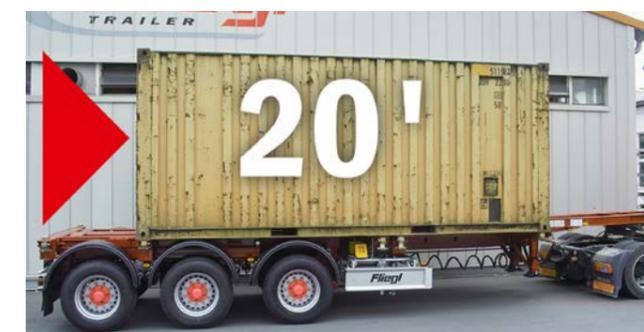
Châssis Vario V3 avec dispositif de positionnement pour les conteneurs de 20 pieds
