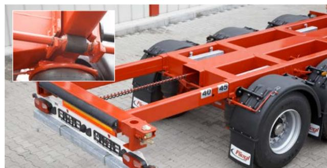
Extension arrière manuelle à roulements à rouleaux : robuste, facile à utiliser et fiable.
