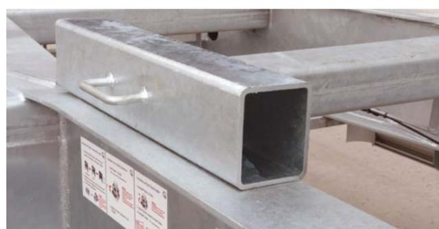
Blocs de soutien stables pour les conteneurs de 20 pieds à l'avant du châssis.
