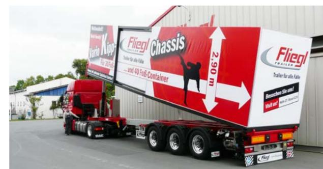
Châssis benne Vario pour conteneurs de 40 pieds télescopé
