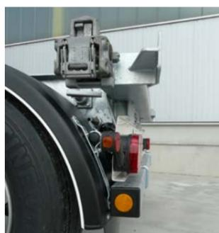
Protection optimale des feux contre les impacts sur les rampes de chargement.
