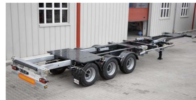
Répartition de la charge et charge verticale optimales grâce au chargement central d'un conteneur de 20 pieds
