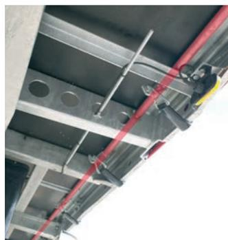
Principe : un dispositif à crochets est installé sous le seuil de chargement. Les sangles de fermeture des bâches sont simplement raccrochées. L'axe pivote alors et les crochets tirent les sangles vers le bas pour tendre la bâche. La rotation dans la direction opposée permet de décrocher les sangles et les bâches peuvent être immédiatement ouvertes.
