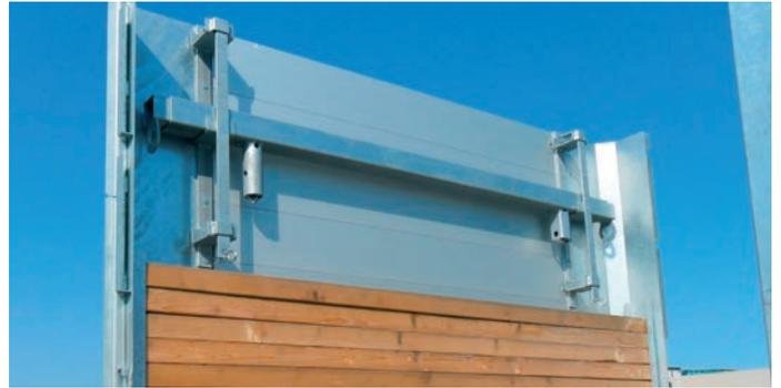
Un compartiment de stockage pour le bois de construction équarri et les éléments du système Vario avec ranchers est intégré dans la paroi avant.
