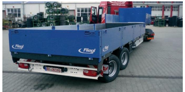
Semi-remorque pour matériaux de construction en version Jumbo à direction hydraulique forcée.
