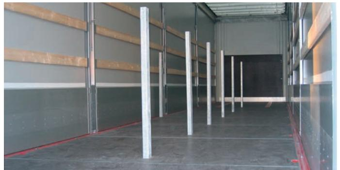
Système de fixation de ranchers avec jusqu'à sept embases de rancher au milieu de l'aire de chargement et sur le cadre extérieur.
