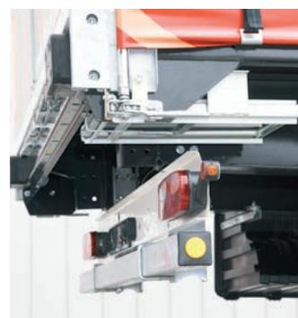
Protection contre l'encastrement avec unité de feux séparée, protégée en étant placée sous le châssis.
