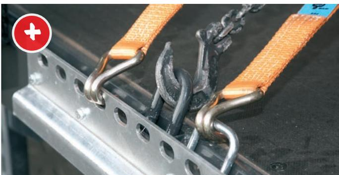
Les semi-remorques de Fliegl offrent de nombreuses possibilités d'arrimage, jusqu'à 500 points d'arrimage par véhicule.
