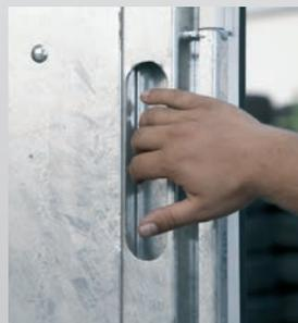
Fliegl relie les rangers d'angle arrière et les portes arrière avec des charnières à double articulation. Celles-ci permettent de rabattre la porte ouverte tout contre les bâches latérales. Comme la porte pivote jusque derrière l'arête du rancher, elle ne peut pas être heurtée. Fliegl intègre une poignée dans le rancher d'angle galvanisé pour monter dans la remorque en toute sécurité.
