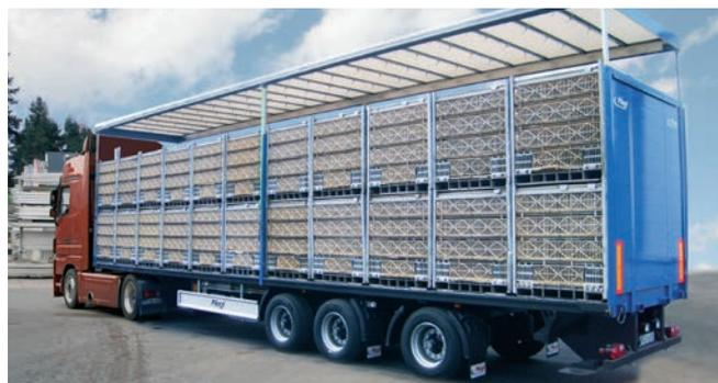
Semi-remorque à rideaux de conception spéciale et toit relevable hydropneumatique prévu pour le transport de volailles.
