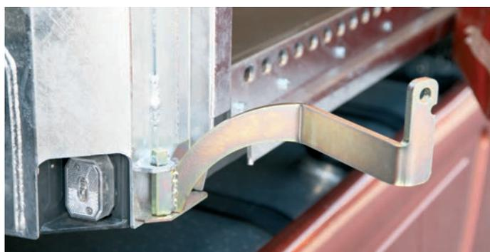
Dispositif d'ouverture des bâches latérales avec un levier très long pour permettre une tension optimale des bâches.
