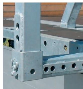
Les ranchers peuvent être déployés jusqu'à 3,50 m pendant le chargement et le déchargement.
