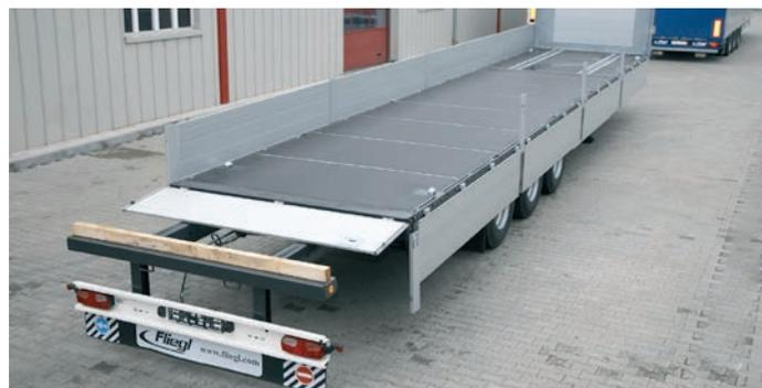
Semi-remorque multifonctionnelle avec dispositifs de verrouillage des conteneurs, extension arrière et embases de rancher.
