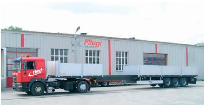
Semi-remorque pour matériaux de construction avec fonction télescopique de 6 m
