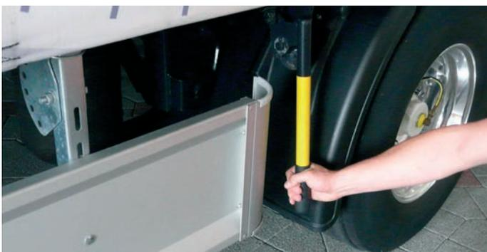
Un levier central permet de commander tous les dispositifs permettant de détendre ou de tendre les bâches en une seule étape.
