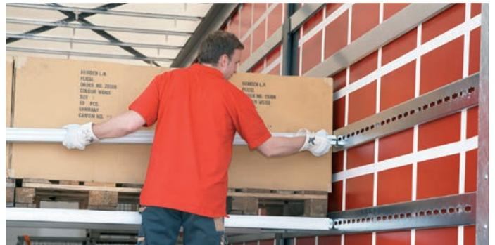
Pour l'arrimage de la charge à l'avant et à l'arrière : lattes de fixation et poutrelles Vario.
