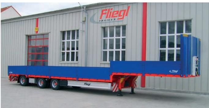
Version Jumbo, en option un rail de fixation pour des rampes en aluminium.
