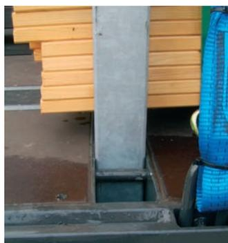
Les ranchers séparables (600/1 200 mm) peuvent être insérés de manière souple dans les traverses.
