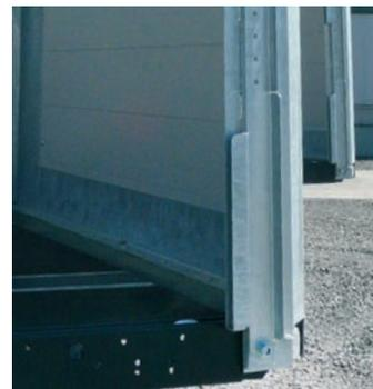
Embases pour les lattes de fixation dans le rancher d'angle où il est protégé contre les dommages qui peuvent être occasionnés par un chariot élévateur à fourches.
