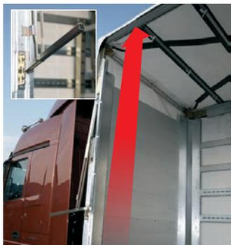
Toit relevable mécanique (380 mm)
