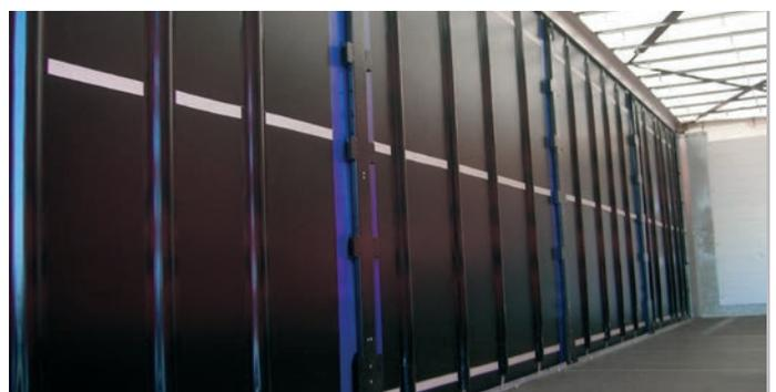
Fliegl renonce aux lattes intégrées à l'horizontale et utilise à la place des profilés en aluminium pour les rideaux coulissants. Un coulissement d'ouverture et de fermeture simple sans enchevêtrement de lattes représente un nouveau gain de temps.
