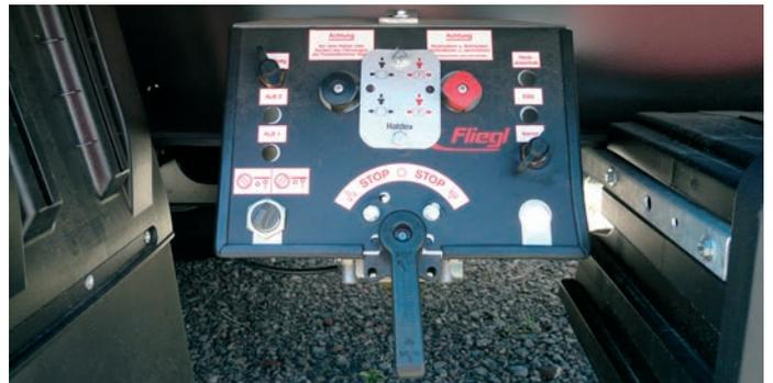
Logique et clair : l'unité de commande de la suspension pneumatique et du frein.
