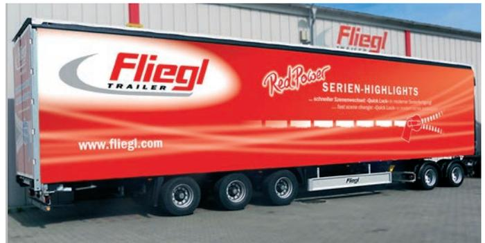
La surface des bâches plus plate sans dispositifs de serrage saillants permet de réduire la résistance au vent de la semi-remorque.
