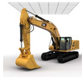
BARRIÈRE ÉLECTRONIQUE AU PLAFOND
