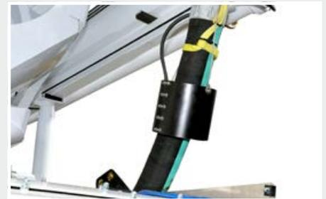
Clapet anti-retour du flexible d'extrémité
