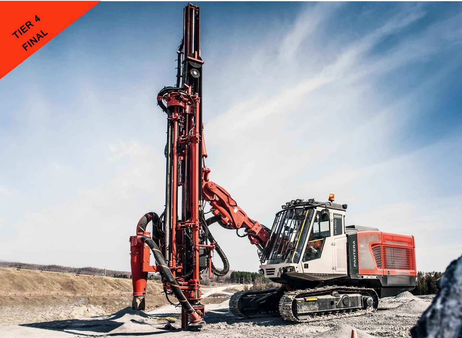
Der Pantera DP1500i ist ein intelligentes, selbstfahrendes Übertagebohrgerät auf Raupen, ausgestattet mit einer Kabine und Stangenwechsler.
