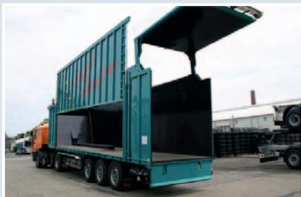
Chargement et déchargement très simples avec ridelles à ouverture hydraulique (en option) et paroi arrière.
