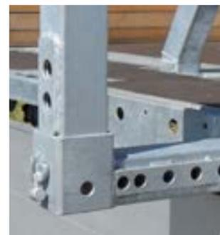
Die Rungen lassen sich zum Be- und Entladen bis 3,50 Meter ausziehen.
