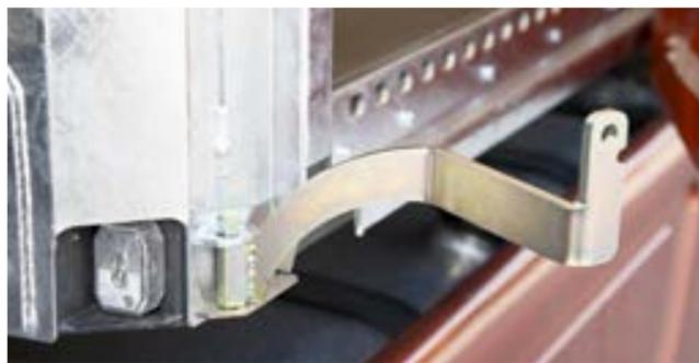
Lösevorrichtung für die Seitenplane mit extra langem Hebel für optimale Spannung der Plane.
