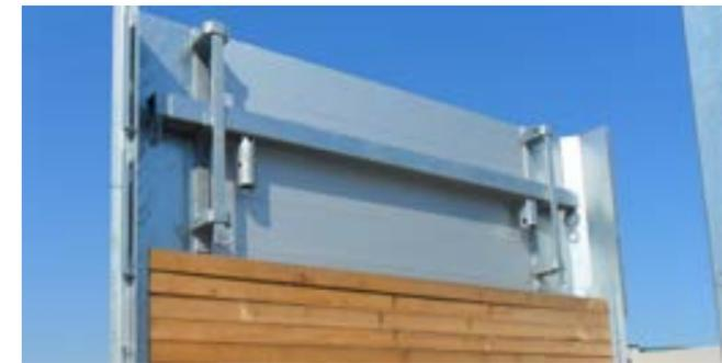
In die Stirnwand ist ein Staufach für Kanthölzer und Elemente des Vario Rungensystems integriert.
