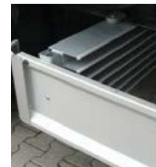
Sind Bordwände und Vario Rungen in speziellen Staufächern untergebracht, steht ein reiner Plateausattel zur Verfügung.
