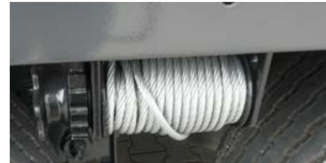
Der Trailer besitzt acht Stahlseilwinden zur Ladungssicherung.
