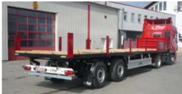
Spezialist für Stahltransporte mit zwangsgelenkter Achse, Heckausschub, Rungenquerleisten und Holzunterlagen.
