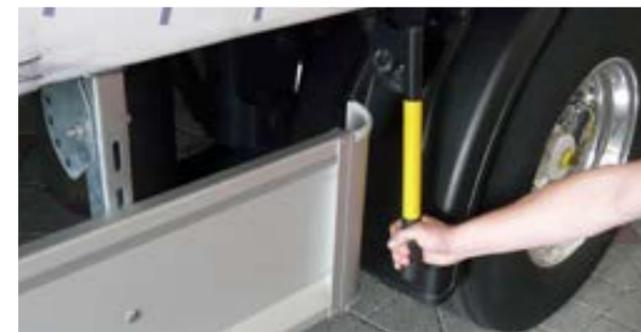
Ein zentral angebrachter Hebel steuert die Welle, über die alle Verschlusschnallen gelöst bzw. gespannt werden – jeweils mit nur einem Handgriff.
