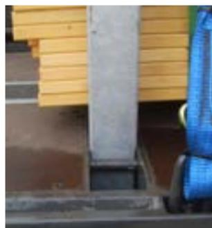
Innerhalb der Rungenquerleisten können die teilbaren Rungen (600 / 1200 Millimeter) flexibel gesteckt werden.
