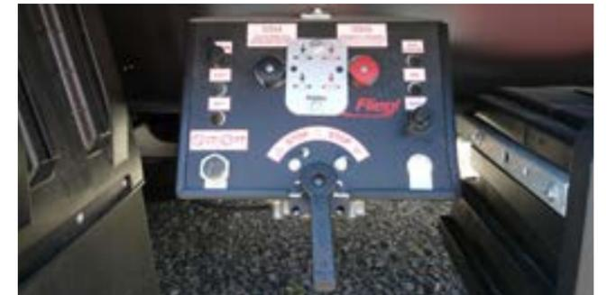
Logisch und übersichtlich: die Bedieneinheit für Luftfederung und Bremse.
