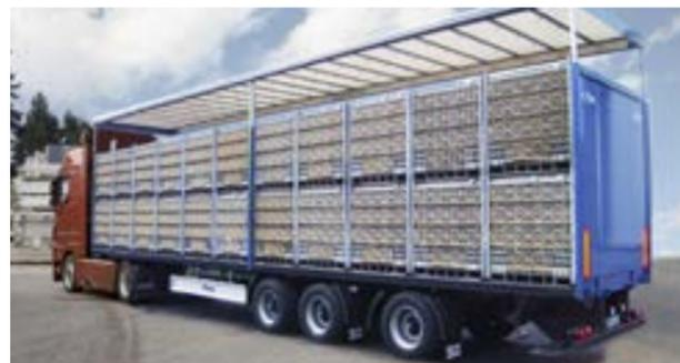
Gardinensattel mit Sonderaufbau und hydropneumatischem Hubdach – Spezialanfertigung für den Geflügeltransport.
