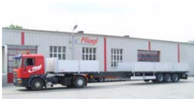
Baustoffsattel mit 6-Meter-Teleskopierung.
