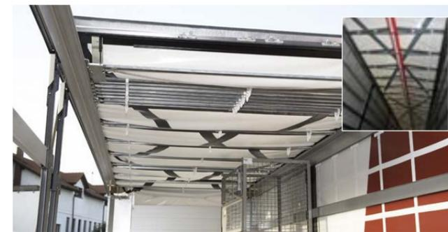
Dachaussteifungen, die so mit dem Schieberdeck verbunden sind, dass sie beim Öffnen des Daches nicht in den Laderaum fallen können. Optional ist ein Anti-Ice System erhältlich.
