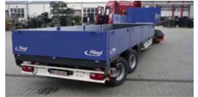
Jumbo-Baustoffsattel mit hydraulischer Zwangslenkung.
