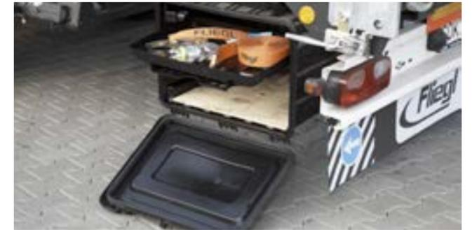
Kunststoff-Staukasten mit Schublade und Einlegeboden.
