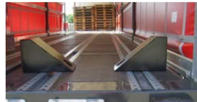
Joloda-Ladesystem mit Schienen, verstellbaren Keilen und Palettenrollern. Dazu gibt es einen passenden Staukasten.
