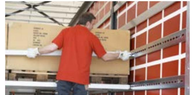
Für die Sicherung der Ladung nach vorn und hinten: Vario Einstecklatten und Vario Balken.
