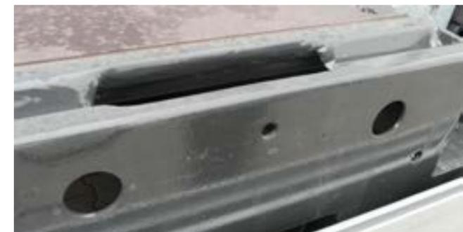
Gesicherte Ladung auch bei geschlossenen Bordwänden: Öffnung zur Durchführung der Stahlseile.
