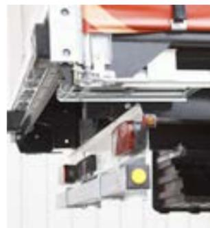
Unterfahrerschutz mit separater Lichteinheit, geschützt unter dem Chassis platziert.
