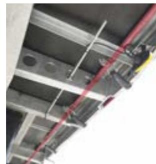
Das Prinzip: Unter der Ladefläche ist eine mit Haken versehene Welle montiert. Die Schlaufen der Planenverschlüsse werden einfach in die Haken eingehängt, anschließend wird die Welle gedreht, die Haken ziehen die Schlaufen nach unten, die Plane wird gespannt. Durch Drehen in die entgegengesetzte Richtung fallen alle Verschlüsse aus den Haken, die Plane kann sofort bewegt werden.
