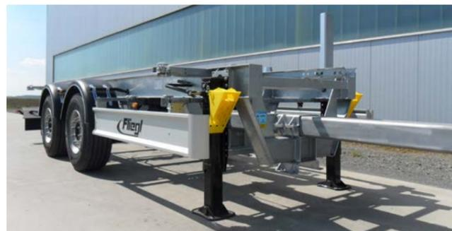
Optional sind Getriebestützwinden erhältlich.
