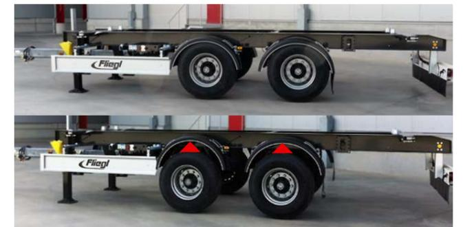
Tandem-Wechselanhänger abgesenkt (oben) und angehoben. Fliegl bietet Langhubaggregate als Option an.
