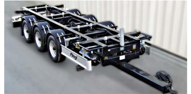
Tridem-Wechselfahrgestell mit Einzelbereifung (Hubhöhe 1030 bis 1380 Millimeter, Fahrhöhe 1150 Millimeter)
