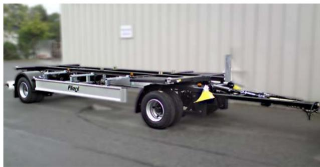
Wechselanhänger in Jumbo-Ausführung mit Zwillingbereifung (Hubhöhe 970 bis 1380 Millimeter, Fahrhöhe 1030 Millimeter).
