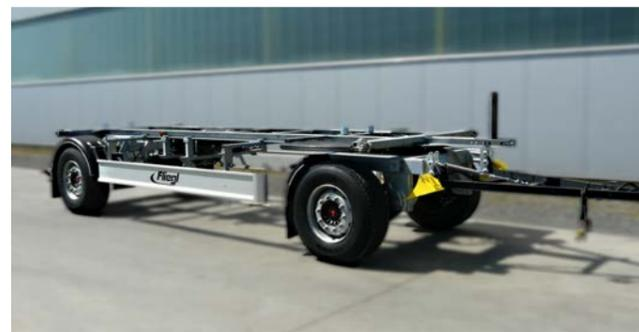
Wechselanhänger in Standard-Ausführung (Hubhöhe 1180 bis 1380 Millimeter, Fahrhöhe 1260 Millimeter).
