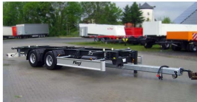
Tandem-Wechselfahrgestell in 17,5 Zoll Jumbo-Ausführung (Hubhöhe 830 bis 1020 Millimeter, Fahrhöhe 870 Millimeter).
