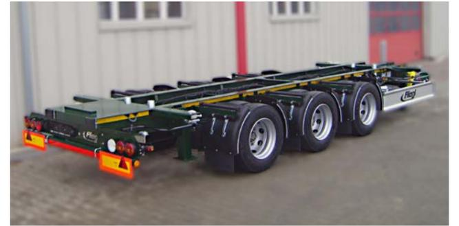
Tridem-Wechselfahrgestell in Jumbo-Ausführung mit 19,5 Zoll Zwillingssbereifung (Hubhöhe 840 bis 1100 Millimeter, Fahrhöhe 890 Millimeter).
