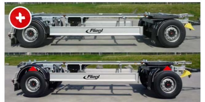
Die Hubfunktion der Fliegl-Drehschemelanhänger: abgesenkt (oben) und angehoben. Der lange Radstand sorgt für besseres Fahrverhalten.
