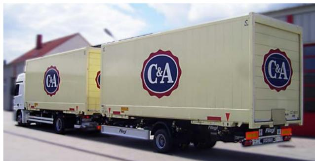
LKW-Zug mit Einachs-Wechselbrückenanhänger.
