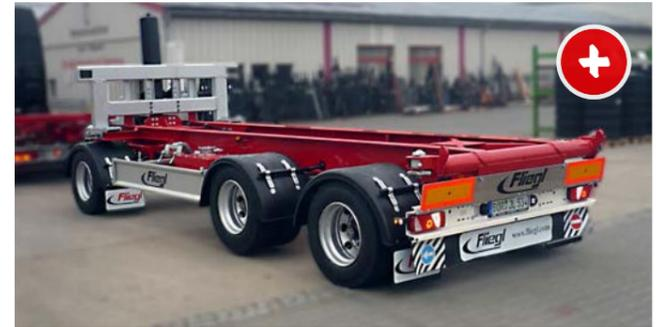
Dreiachs-Wechselfahrzeug mit Kippfunktion für 20 Fuß Container.
