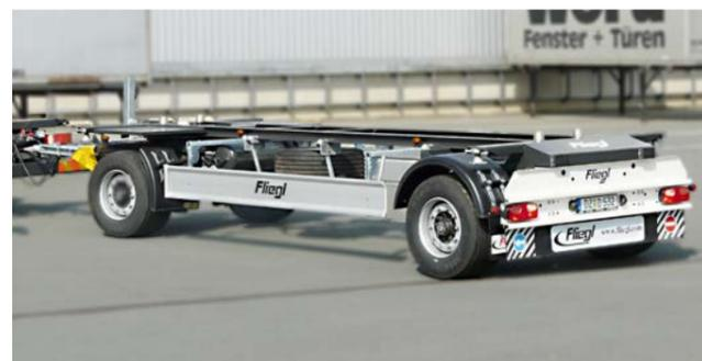
Wechselanhänger in Jumbo-Ausführung mit Einzelbereifung (Hubhöhe 980 bis 1380 Millimeter, Fahrhöhe 1080 Millimeter).
