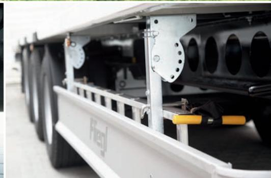
Fond mouvant pour un meilleur déchargement vidange de la marchandise, cadre en profilés aluminium avec bâche. Le fond mouvant est mobile vers l'arrière et l'étanchéité latérale est assurée par des bandes de bâche.
