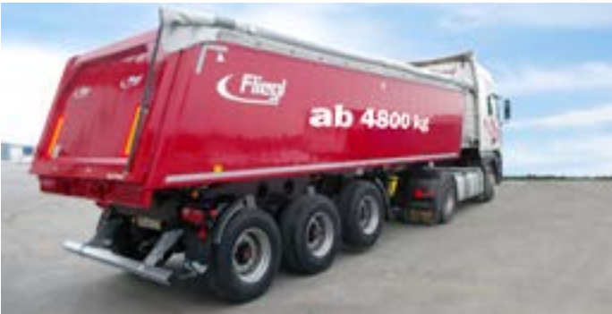
27 Kubikmeter Mulde ab 4,8 Tonnen Leergewicht
