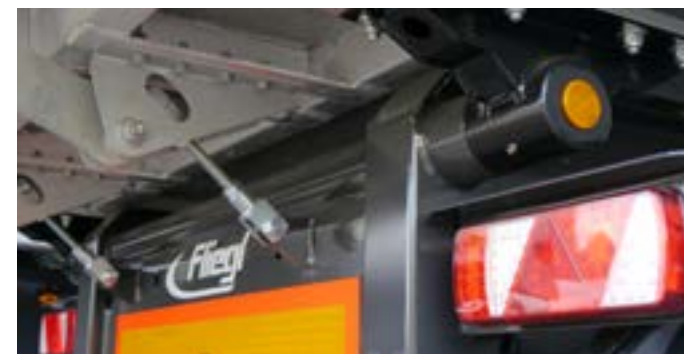
Durchgehende Kippwelle am Heck mit stabilen, geschlossenen Muldenkipplagerungen zum Schutz vor Verschmutzung
