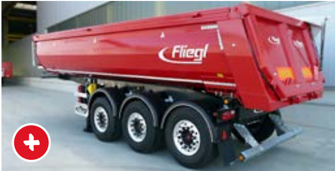
Stone Master light mit 22 Kubikmeter Mulde ab 5,4 Tonnen Leergewicht
