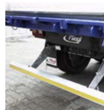
Klappbarer Unterfahrschutz aus Stahl (links) und Aluminium (rechts) für Fertigerbetrieb
