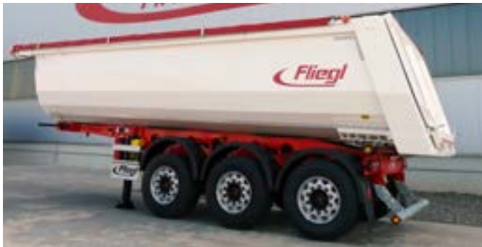
Stone Master light mit 28 Kubikmeter Mulde ab 5,9 Tonnen Leergewicht
