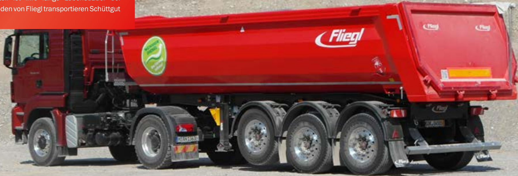
Stone Master light mit 22 Kubikmeter Mulde ab 5,4 Tonnen Leergewicht
