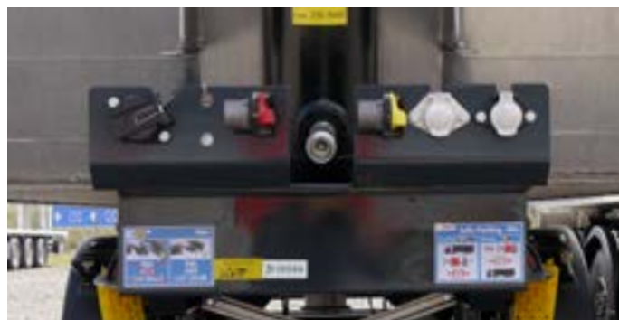
Die Versorgungsanschlüsse sind gut zugänglich im vorderen Bereich des Chassis angebracht.
