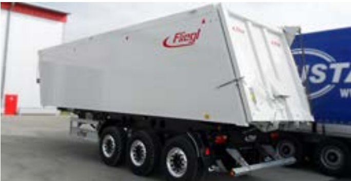
50 Kubikmeter Mulde in langer Ausführung ab 5,6 Tonnen Leergewicht
