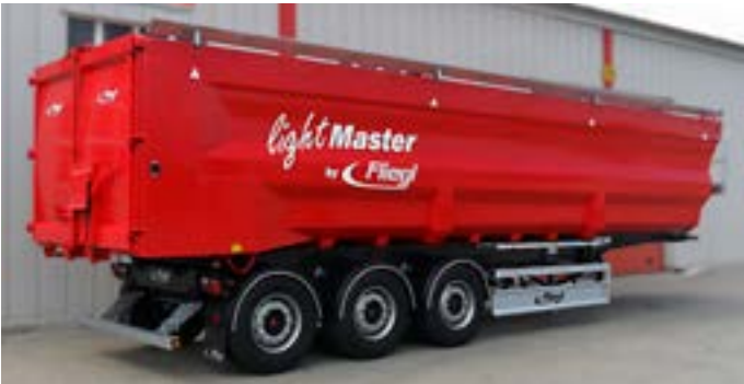
Light Master mit 50 Kubikmeter Mulde und serienmäßigem Aluschutzblech für eine Rollplane
