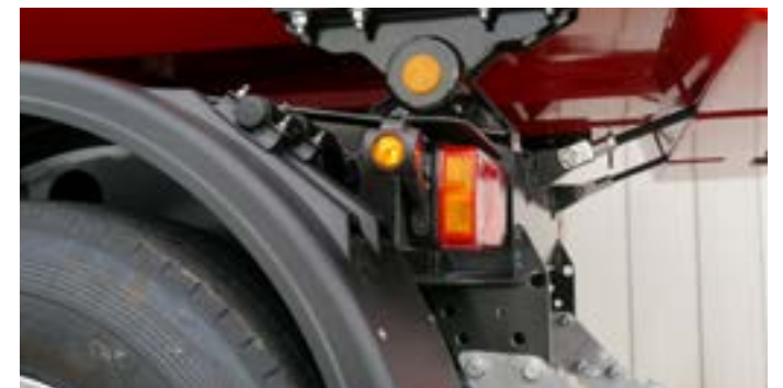
Optimal geschützte Lichteinheit zur Vermeidung von Beschädigungen
