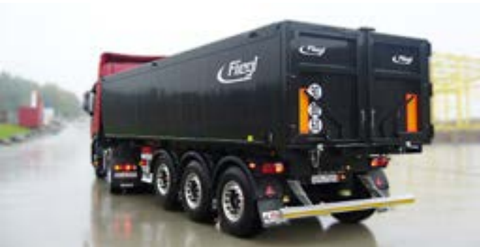
29 Kubikmeter Mulde ab 5,1 Tonnen Leergewicht
