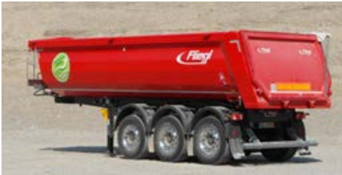
Stone Master light mit 25 Kubikmeter Mulde ab 5,5 Tonnen.
