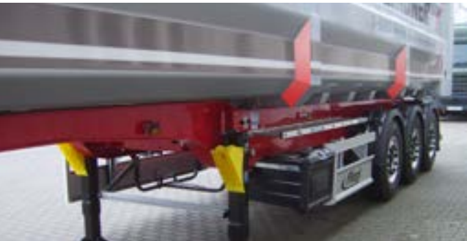
... mit glatter Oberfläche für geringen Luftwiderstand ...
