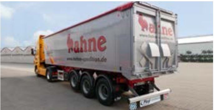
50 Kubikmeter Mulde ab 5,8 Tonnen Leergewicht
