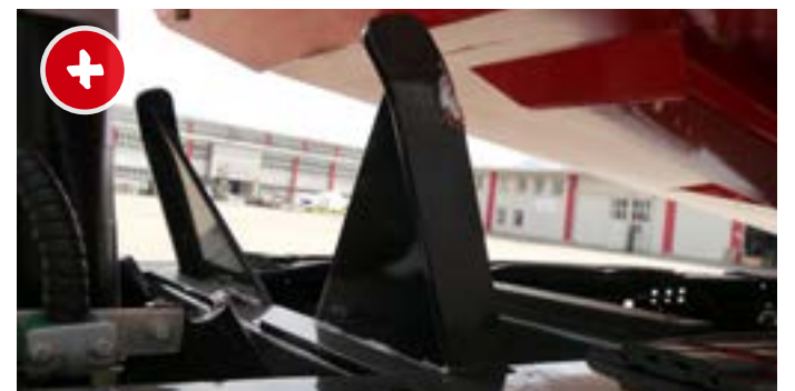
Stabile Einweiskeile zur Fixierung der Mulde
