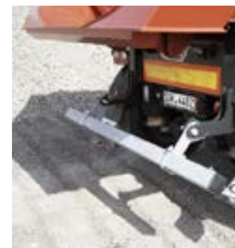
Klappbarer Unterfahrschutz aus Stahl (links) und Aluminium (rechts) für Fertigerbetrieb
