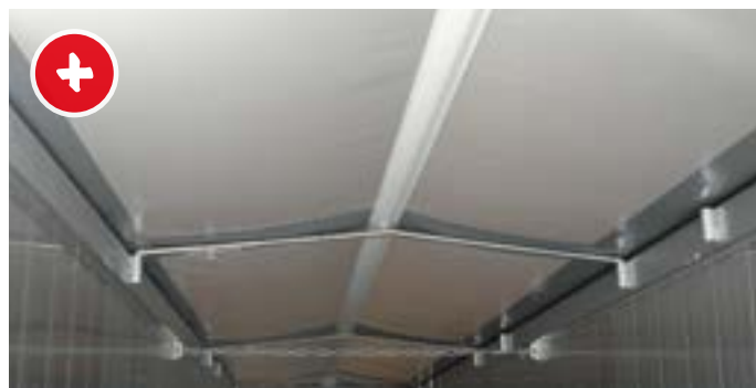
Das Mittelauflegerohr bei Volumenmulden verhindert ein Durchhängen der Plane und vermeidet Wasseransammlungen.
