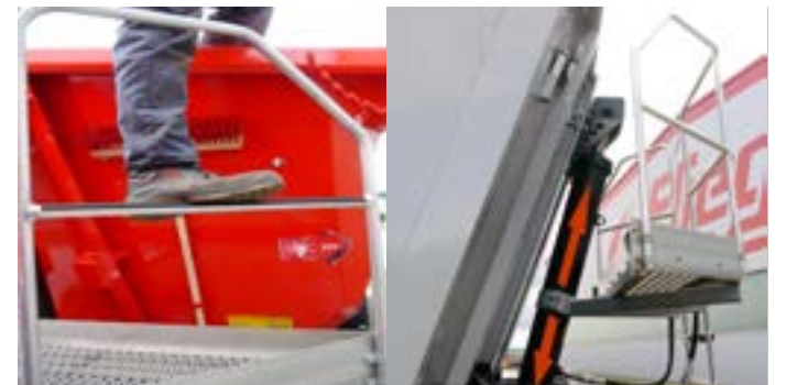
Stehpodest mit Antirutsch Aufstieg
