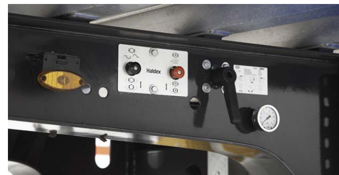
Übersichtliche Bedieneinheit direkt am Längsträger
