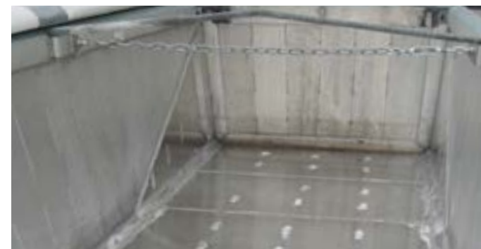
Verschleißecken am hinteren Muldenende sowie verstärkter Muldenboden
