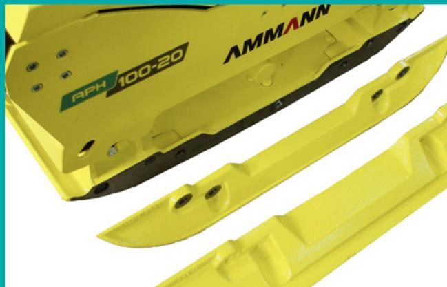
Les plaques d'extension, disponibles en 2 tailles différentes, augmentent la surface de compactage et la productivité. L'ajout d'une extension se fait en réglant 4 vis par côté, ce qui peut être réalisé rapidement, directement sur le chantier.
