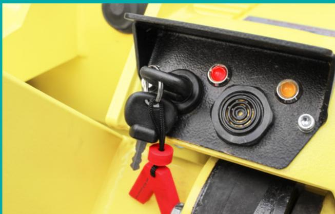
Les versions à démarreur électrique lancent le compacteur à plaque. Ce système est très pratique pour les conducteurs d'engin expérimentés, et aide également les nouveaux à se lancer sans effort.
