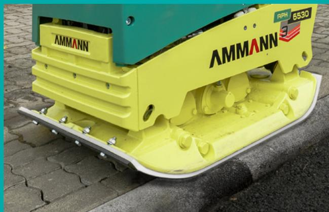
Les tapis sont fixés sur les plaques et évitent toute cassure ou tout craquement des pierres de pavage ou d'autres matériaux sensibles, tout en fournissant la puissance de compactage requise. L'installation des plaques vulcollan est simple à réaliser et peut se faire directement sur le chantier.
