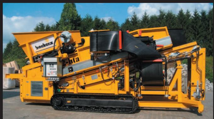
Material-Befüllung mit Hilfe von Teleskoplader, kleinem Radlader, Midi-Bagger oder Bagger mit Rotorschaukel.
