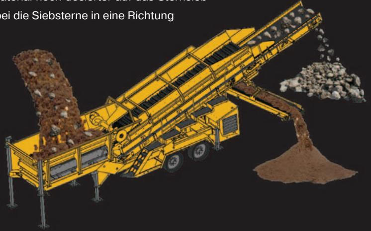
**Die optimale Absiebungsgröße für die Sternsiebtechnik liegt bei  $>6$  mm.**
