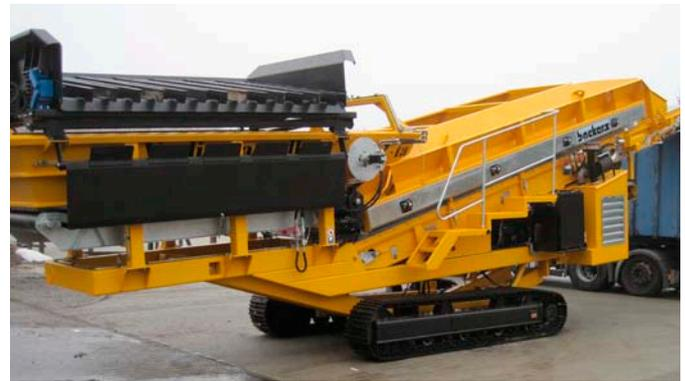
Einsatz Bauschutttrennung in 3 Fraktionen durch Vorseparierung großvolumiger Materialanteile mit Hilfe eines Vibrorostes.
