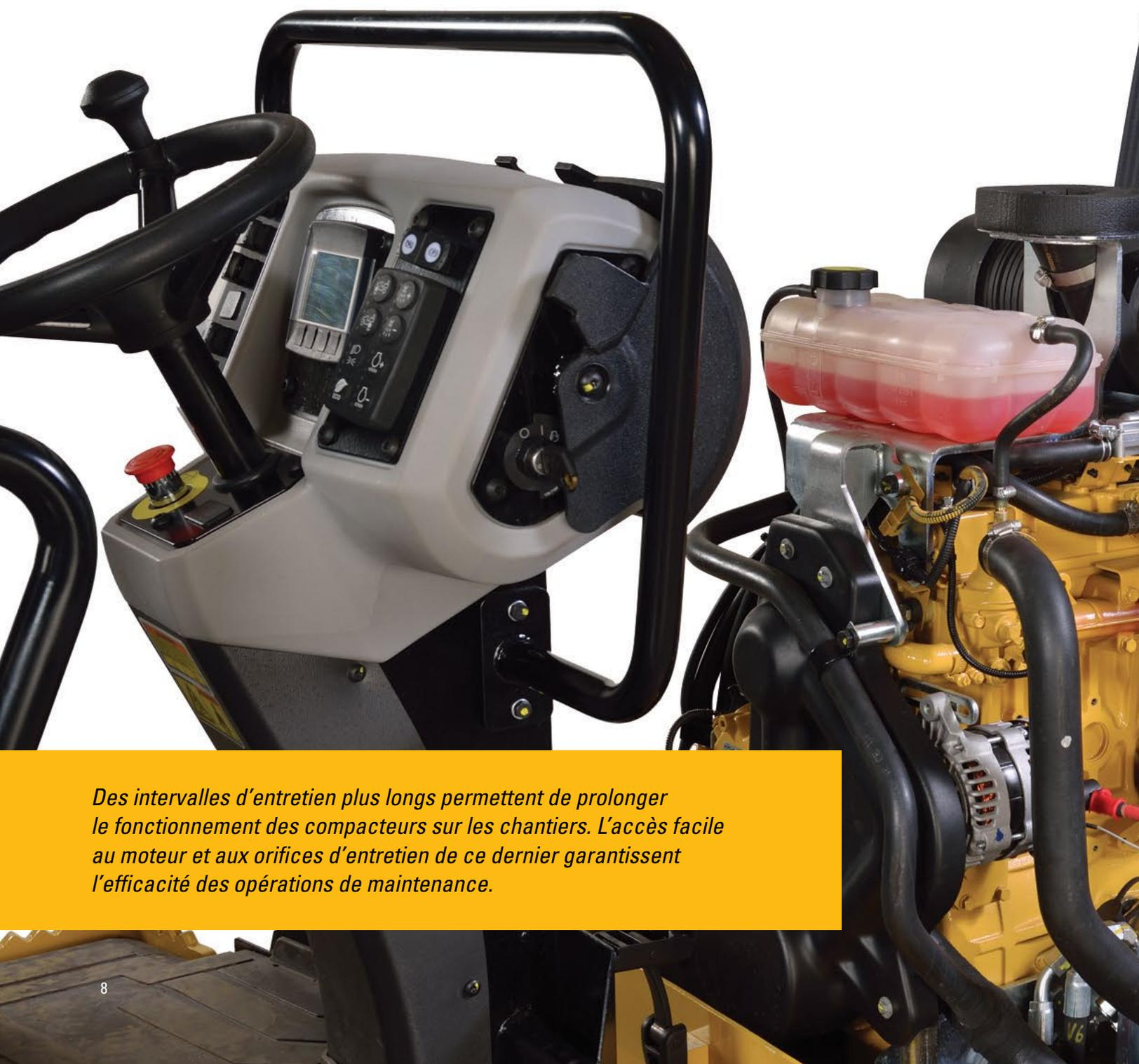
*Des intervalles d'entretien plus longs permettent de prolonger le fonctionnement des compacteurs sur les chantiers. L'accès facile au moteur et aux orifices d'entretien de ce dernier garantissent l'efficacité des opérations de maintenance.*
