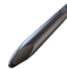
Der **Pyramidenmeißel** ist eine Weiterentwicklung des Spitzmeißels und für penetrative Arbeiten gedacht. Seine Pyramidenform ermöglicht eine optimale Positionierung und eignet sich perfekt für allgemeine Arbeiten durch hervorragendes Eindringen und gute Keilwirkung. Die schneidenden Kanten helfen beim Brechen und Trennen des Materials.
