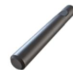
Der **Stumpfmeißel** überträgt die volle Schlagkraft des Hydraulikhammers direkt in das Material, daß er zerkleinern soll. Die Schlagwelle zerstört die Strukturen und löst die Armierung vom Beton.
