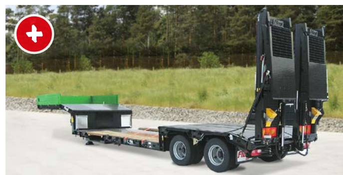
Semi-remorque à deux essieux surbaissée et fonction télescopique.
