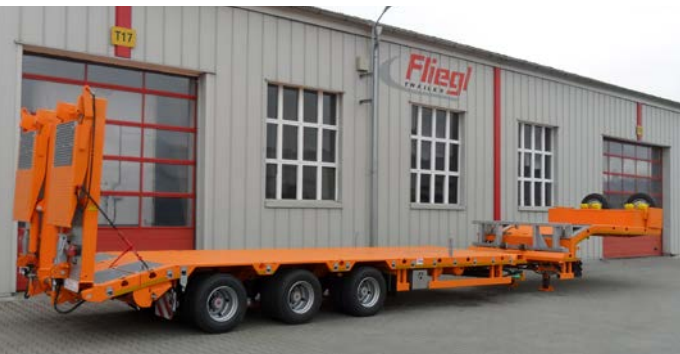
Semi-remorque surbaissée à direction hydraulique et fonction télescopique
