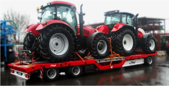
Remorque surbaissée à trois essieux à plate-forme droite, logement de roue et barre de fixation pour les rampes en aluminium, rangées au milieu.
