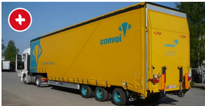
Semi-remorque surbaissée à rideaux coulissants pour protéger les chargements sensibles et pour la souplesse d'utilisation.
