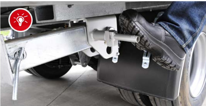
Support arrière mécanique rabattable avec commande au pied pratique
