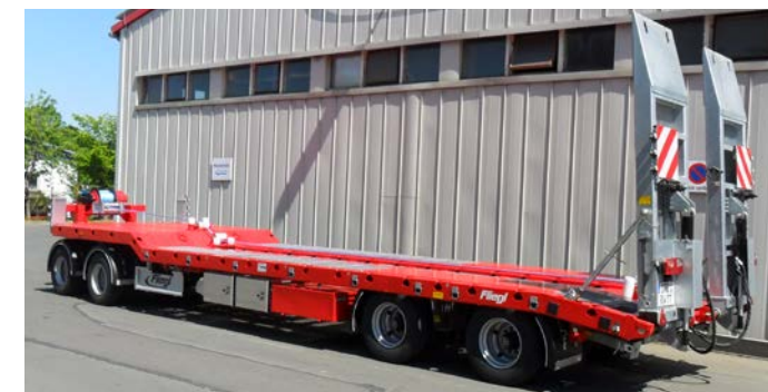
Version XL avec treuil hydraulique, caméra de vision arrière, caillebotis en acier, multiples options d'arrimage, etc.
