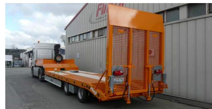
Rampe d'accès continue pour le transport de chariots élévateurs à fourches, par exemple
