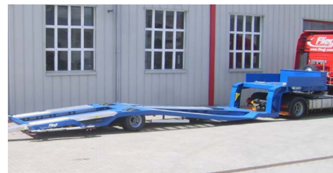
Remorque surbaissée à un essieu avec une charge utile de 15 tonnes maximum ...
