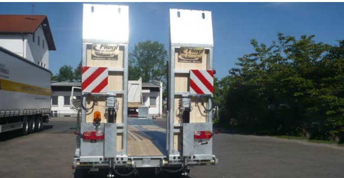
Rampes hydrauliques avec caillebotis denté, 2 800 x 750 mm.
