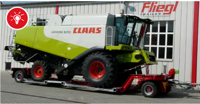
Remorque surbaissée à deux essieux pour le transport de machines agricoles et de tracteurs routiers.
