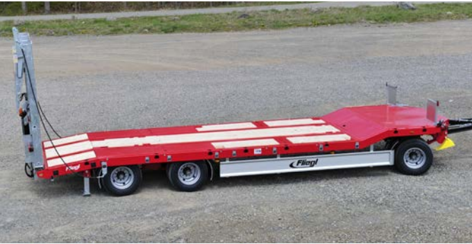
Remorque surbaissée en version coudée avec une hauteur de charge d'environ 860 mm
