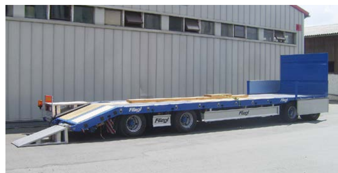
Remorque à quatre essieux à plate-forme droite et une hauteur de charge d'environ 980 mm
