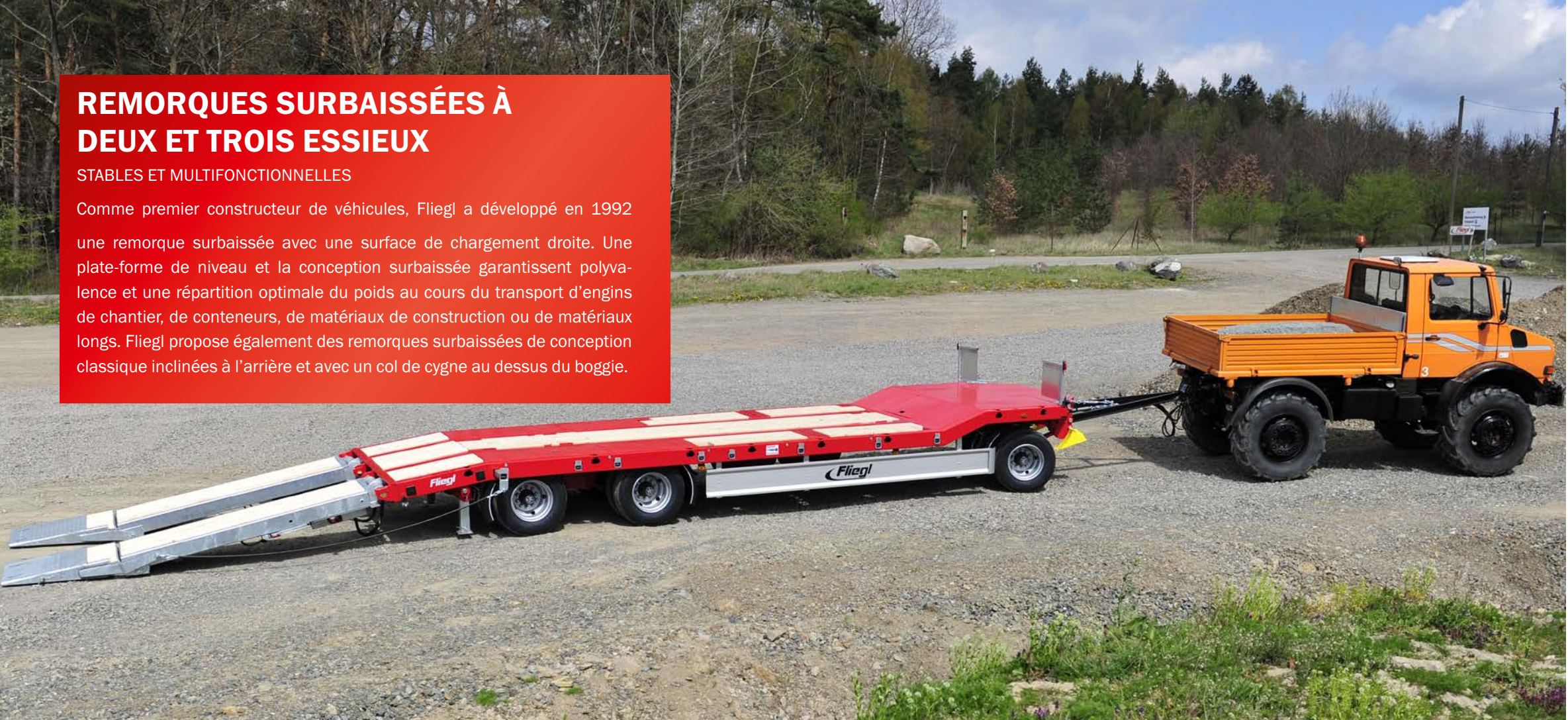
Remorque à trois essieux à plate-forme droite et une hauteur de charge d'environ 900 mm
