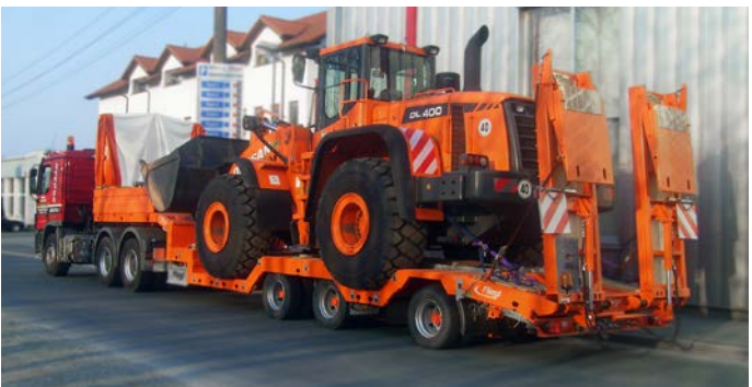
Semi-remorque surbaissée à trois essieux avec deux paires de logements de roue pour le transport de chargeurs sur roues
