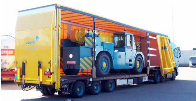
Semi-remorque surbaissée à rideaux coulissants pour protéger les chargements sensibles et pour la souplesse d'utilisation.
