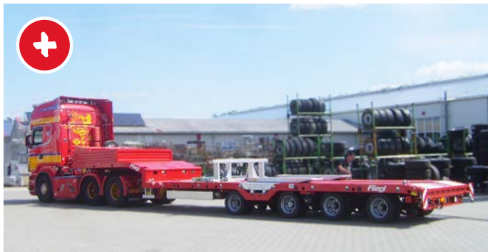
Semi-remorque surbaissée avec fonction télescopique et une hauteur de chargement d'environ 820 mm.
