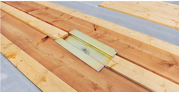
Les planches de bois pour l'élargissement de la plate-forme surbaissée peuvent être stockées au milieu de l'aire de chargement (à droite) ou en option sous le seuil de chargement.
