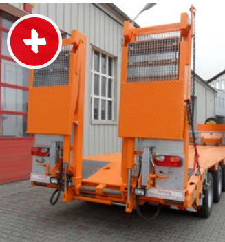
Rampes divisées sur le passage du treuil avec caillebotis denté, 4 200 x 750 mm.
