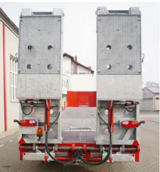
Rampes pour le Liftmaster de Fliegl avec caillebotis denté, déplacement latéral à commande hydraulique, 4 450 x 850 mm.
