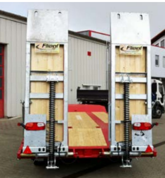
Rampes à revêtement de bois, actionnées à l'aide d'un levier à ressort, 2 800 x 750 mm.
