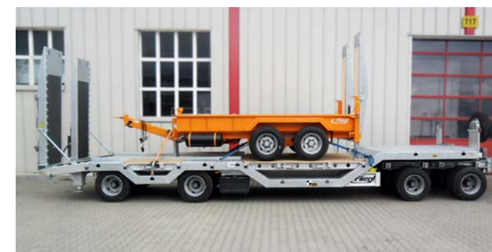
Remorque surbaissée à quatre essieux avec deux paires de logements de roue en version galvanisée
