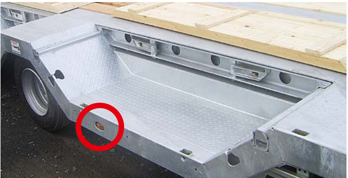
Fliegl installe des logements de roue de différentes versions. L'éclairage du marquage latéral est protégé et intégré dans le cadre extérieur.
