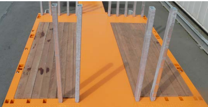
Les semi-remorques surbaissées de Fliegl peuvent être équipées de différents systèmes de ranchers.
