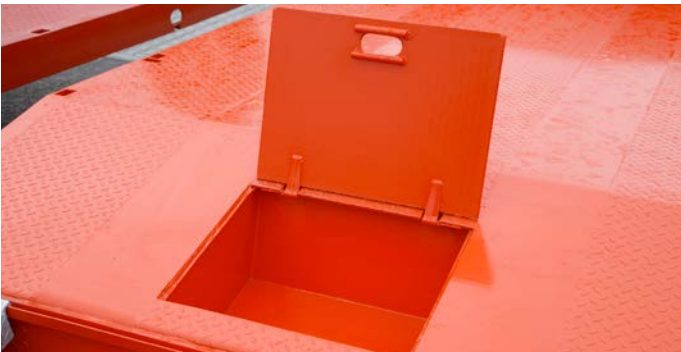
Compartiment de stockage en série dans l'inclinaison de passage du col de cygne.
