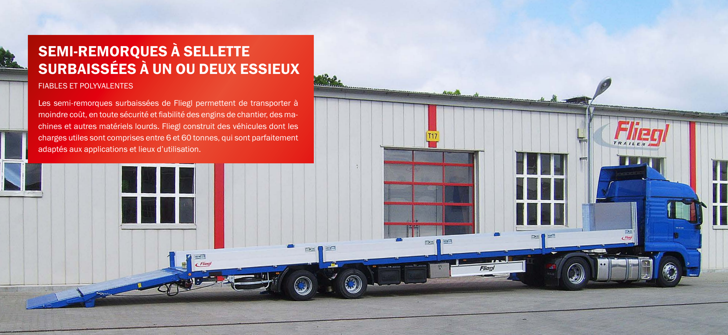
Remorque surbaissée à un essieu avec une charge utile de 15 tonnes maximum ...
