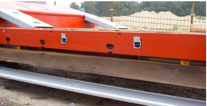
Les planches de bois pour l'élargissement de la plate-forme surbaissée peuvent être stockées au milieu de l'aire de chargement (à droite) ou en option sous le seuil de chargement.
