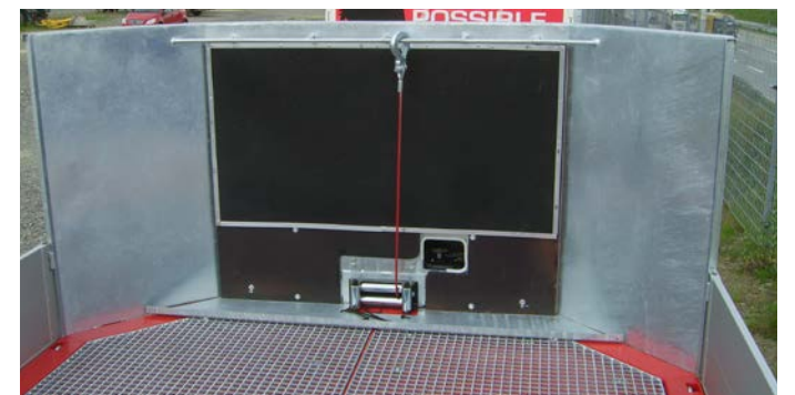
Paroi avant d'une hauteur de 1 200 mm avec rail de fixation pour les sangles et les chaînes
