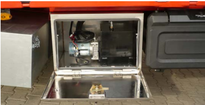
Ensemble électrohydraulique pour commander les rampes d'accès
