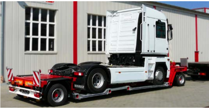
Remorque surbaissée à deux essieux pour le transport de machines agricoles et de tracteurs routiers.
