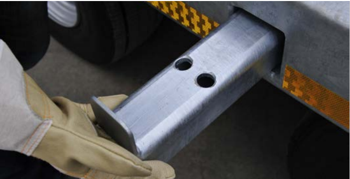
Extensions télescopiques pour élargir l'aire de chargement de 3 m...
