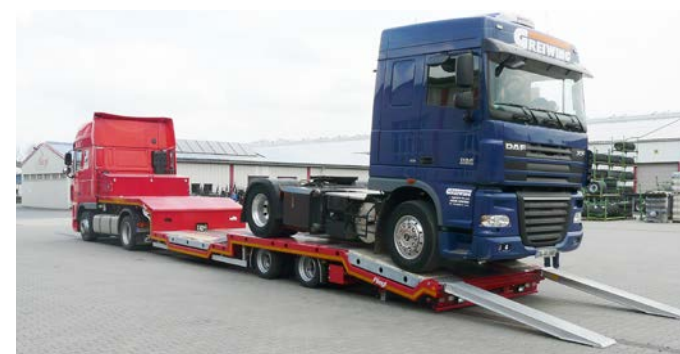
Semi-remorque surbaissée à deux essieux pour transporter jusqu'à deux tracteurs routiers à sellette en cas de transfert, location, récupération, etc.
