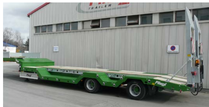
Semi-remorque surbaissée à deux paires de logements de roue pour le transport de machines agricoles et d'engins de chantier.
