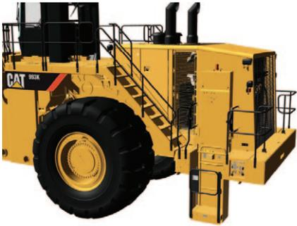
**Fahrerlift.** Anstelle der linken Aufstiegsleiter kann ein Lift installiert werden, der Fahrer, Servicetechniker und Wartungspersonal bis auf Plattformhöhe befördert.
