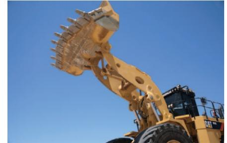
**Gelenkbolzen.** Die exklusiven, langlebigen Cat Gleitlager-Gelenkbolzen sind mit Öl gefüllt und vollständig wartungsfrei. Dadurch entfällt das tägliche Schmieren der Arbeitsausrüstung, sodass sich die Maschinenverfügbarkeit verbessert.
