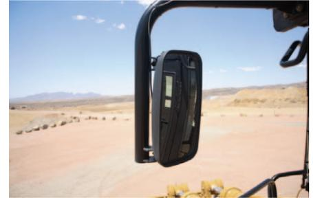
**Sonderausrüstung.** Optionale Ausrüstung ermöglicht eine gezielte Verbesserung der Arbeitssicherheit bei spezifischen Einsatzbedingungen. Beheizbare Außenrückspiegel bringen deutlich mehr Sicherheit in der kalten Jahreszeit. Für Arbeiten in der Dunkelheit empfehlen sich Xenon-Scheinwerfer, die eine wesentlich stärkere Ausleuchtung der Abbausohle in Steinbrüchen und Tagebauen bewirken.
