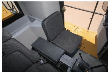
**Fahrersitz.** Zur Standardausrüstung gehört ein luftgefederter Cat Komfortsitz mit automatischer Lendenwirbelstütze und Sechsweg-Verstellung, die eine individuelle Anpassung an unterschiedlichste Körpergrößen gestattet. Die rechte Armlehne lässt sich zusammen mit der integrierten Steuerhebelkonsole verstellen. Auf Wunsch ist eine Sitzheizung lieferbar.
