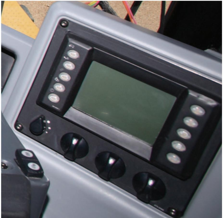
**Cat Product Link.** Das Ortungs- und Datenerfassungssystem Product Link nutzt die Möglichkeiten der modernen Satellitentechnik, um eine dialogfähige Verbindung zur Maschine herzustellen.
