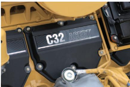
**DIESELMOTOR.** Im Radlader 993K ist der Cat® Dieselmotor C32 installiert, der die Emissionsgrenzwerte gemäß EPA Tier 2 und EU-Stufe II unterschreitet. Dieser bewährte, effiziente und spontan ansprechende Motor mit mechanisch-hydraulischem Hochdruck-Direkteinspritzsystem kommt auch in 777F, 854K, 992K und D11 zur Anwendung.
