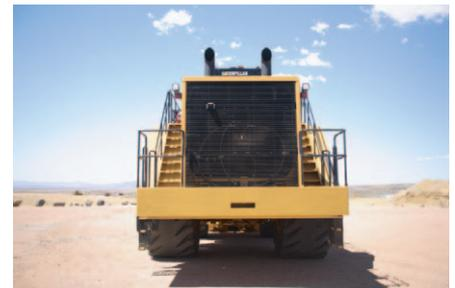
**Aufstiegstreppen.** Über die beiden serienmäßigen Aufstiegstreppen mit 60 cm Breite gelangen Fahrer und Wartungspersonal bequem und sicher in die Kabine oder auf die Wartungsplattform. Sofern notwendig, ist die Maschine mit Kotflügeln lieferbar, um eine Verschmutzung der Stufen und Griffstangen zu vermeiden.
