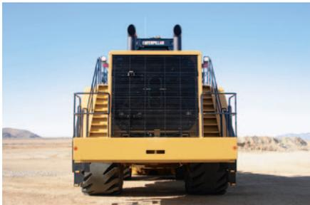
• **Modulwasserkühler.** Der Modulwasserkühler besteht aus 14 rüttelfesten Parallelstrom-Teilblöcken, die für hohe Kühlleistung sorgen und sich bei Bedarf leicht aus- und einbauen lassen.
