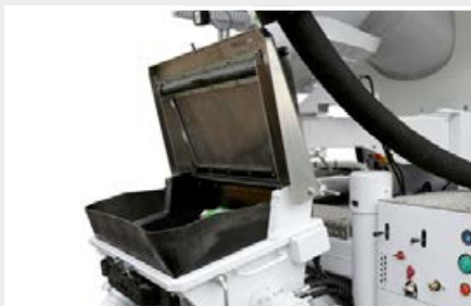
Trichterabdeckung in Stellung „Externe Befüllung“
