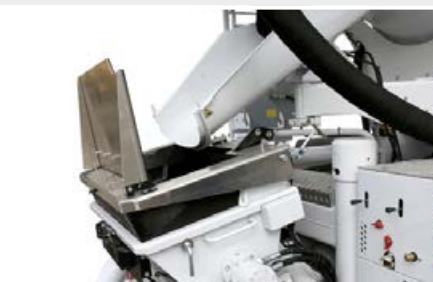
Trichterabdeckung in Stellung „Eigene Befüllung“
