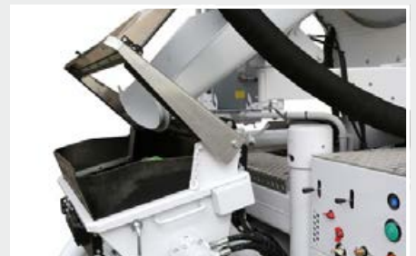
Trichterabdeckung in Stellung „Eigene + externe Befüllung“
