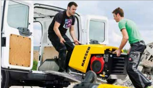
Die kleinsten MOBILAIR-Kompressoren betreiben Druckluftspaten, -hämmer, -bohrmaschinen, -sägen, -schrauber, -schleifer oder Erdraketen. Die 15-bar-Version eignet sich ideal zum grabenlosen Verlegen von Glasfaserkabeln oder für Dichtheitstests. Optional sorgt ein externer Druckluft-Nachkühler für kühle, kondensatfreie Druckluft oder eine externe Filterkombination für technisch ölfreie Druckluft.
