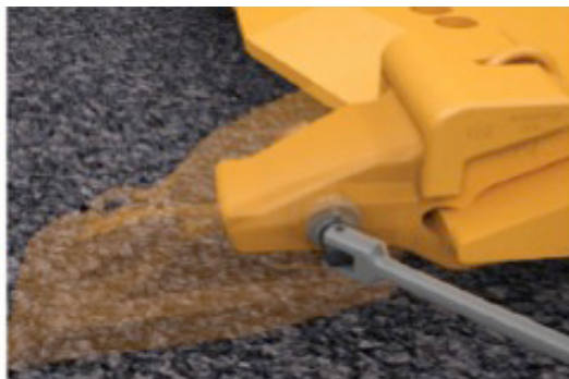
Halbe Drehung öffnet die Sicherung
