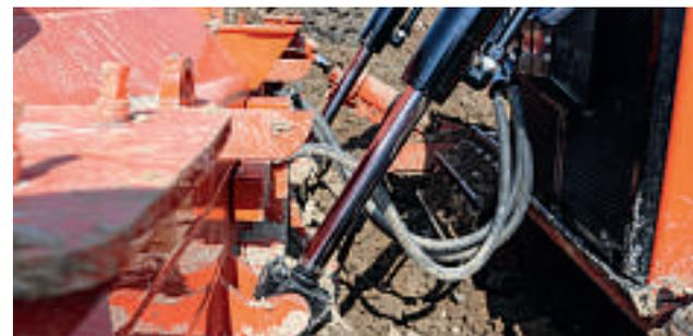
L'AutoCarry™ fait partie du pack technologique dans la Cat D6 XE. Il automatise le levage de la lame afin de maintenir le remplissage souhaité de la lame et réduit en même temps le patinage des chaînes.
