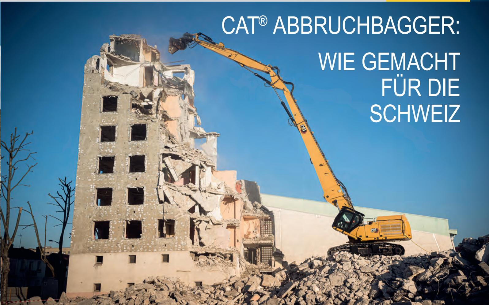
Merkmale wie grössere Standfläche, hydraulisches Verstellfahrwerk und Sicherheitsfunktionen erlauben es dem Maschinisten, die grossen Reichhöhen der Abbruchbagger Cat 352 UHD (Bild) und Cat 340 UHD voll auszunutzen.
