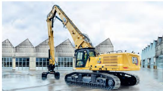
Durch die vergrösserte Standfläche bieten die Bagger (im Bild: Cat 340 UHD) quer und längs nahezu identische Standfestigkeit.
