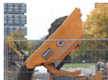
Herausragend robust: Die Mulde des 2263 fasst 3.15 m<sup>3</sup> und ist vollständig verschweisst.
