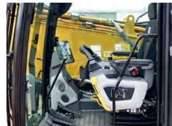
Die Hydraulikventile werden elektrisch gesteuert. Das erlaubt schnelle und gleichzeitig präzise Maschinenbewegungen.
