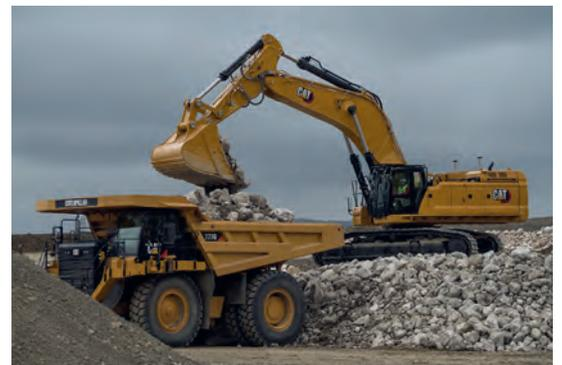
Der separate Schwenkantrieb ist neu in den Grossmaschinen Cat 352, 374 und 395 (Bild). Dadurch sind kraftvolle Bewegungen von Ausleger, Oberwagen und Fahrwerk gleichzeitig möglich.
