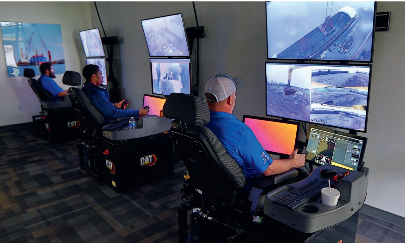
Cat Command wird in den USA zum Beispiel auf Deponien mit unsicheren Bodenverhältnissen genutzt. Der Maschinist bedient den Bagger an der Konsole in einem Gebäude.
