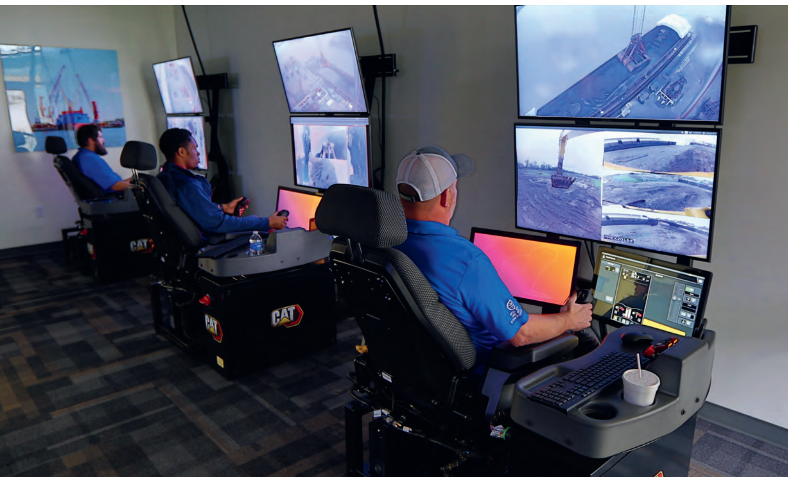
Negli Stati Uniti, Cat Command viene utilizzato nelle discariche con condizioni di terreno instabili e rischiose. L'operatore manovra l'escavatore da un altro edificio, tramite consolle e monitor.
