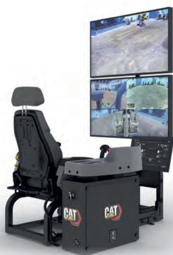
Consolle di comando del nuovo Cat Command
