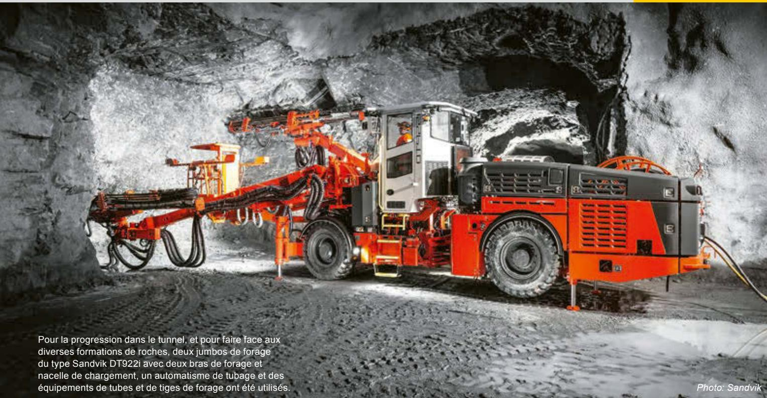
Pour la progression dans le tunnel, et pour faire face aux diverses formations de roches, deux jumbos de forage du type Sandvik DT922i avec deux bras de forage et nacelle de chargement, un automatisme de tubage et des équipements de tubes et de tiges de forage ont été utilisés.
