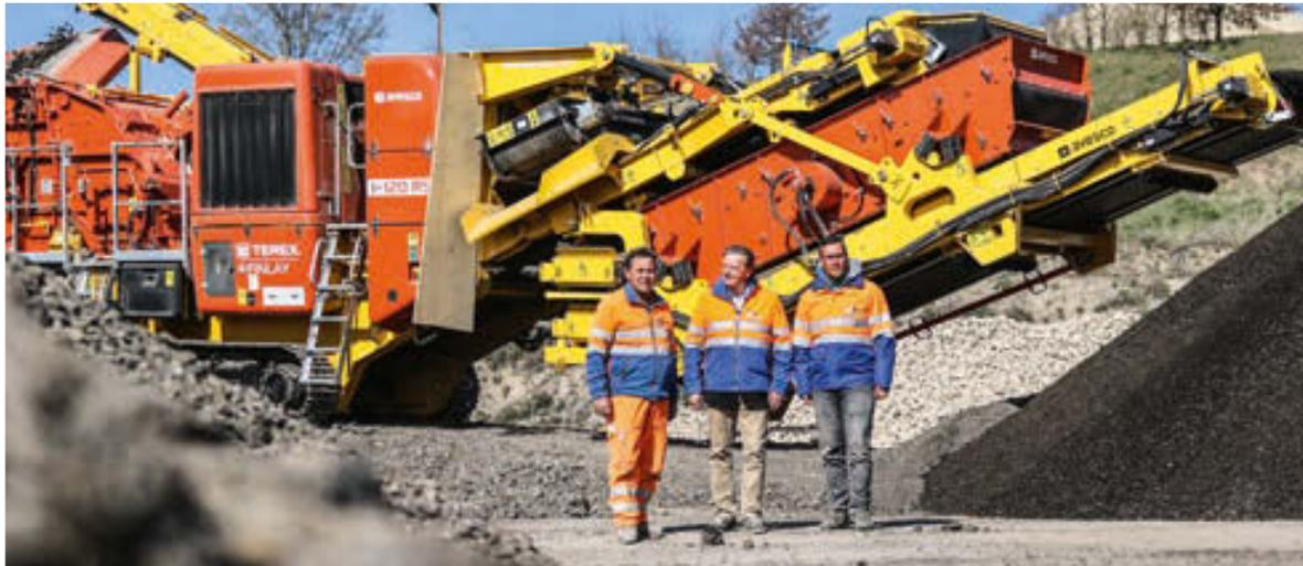
Grâce à sa construction mobile avec train de chenilles, l'installation de préparation peut être déplacée simplement et rapidement d'un endroit à un autre.
