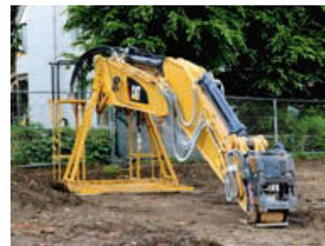
Changement d'équipement en 20 minutes seulement, grâce aux nouveaux raccords hydrauliques. Le machiniste travaille seul et sans outils, un châssis de transport avec échelle garantit la sécurité du travail.
