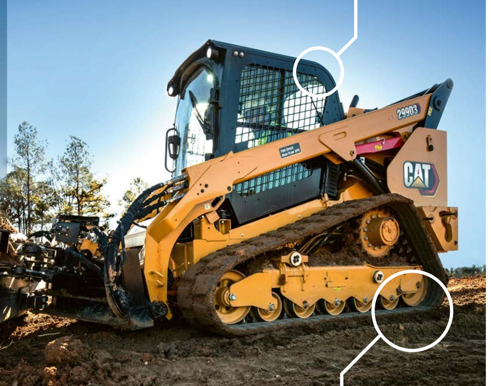
conducteurs n'ont plus ensuite qu'à enfoncer deux boutons sur le module d'affichage pour modifier la configuration des commandes de manipulateur de la machine et utiliser cette dernière comme une véritable pelle hydraulique, niveleuse ou lame de refoulement».
