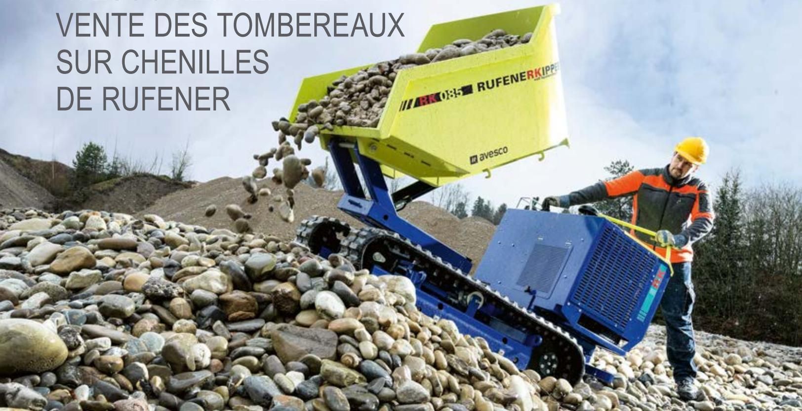
La transmission entièrement hydrostatique, montée dans tous les modèles, offre un avancement avec un très grand confort et des manœuvres en toute sécurité, même sur les terrains en pente.
