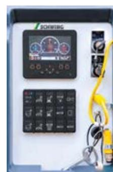
La structure claire et nette de la manipulation et le display couleur grand format de la commande de la machine assurent un maniement simple et intuitif de la TP 100. Les données de la machine, les états de fonctionnement et les paramétrages choisis sont rapidement appelables. Le système de diagnostic intégré indique à l'exploitant les intervalles d'entretien.
