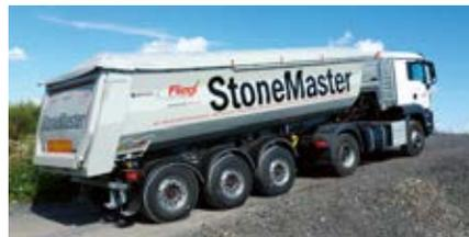
Dans la comparaison industrielle, la Stone Master light atteint un seuil de chargement de près de 40 cm plus bas avec le même volume de chargement, ceci étant dû, entre autres, à la forme conique de la benne et à la hauteur optimisée du châssis.
