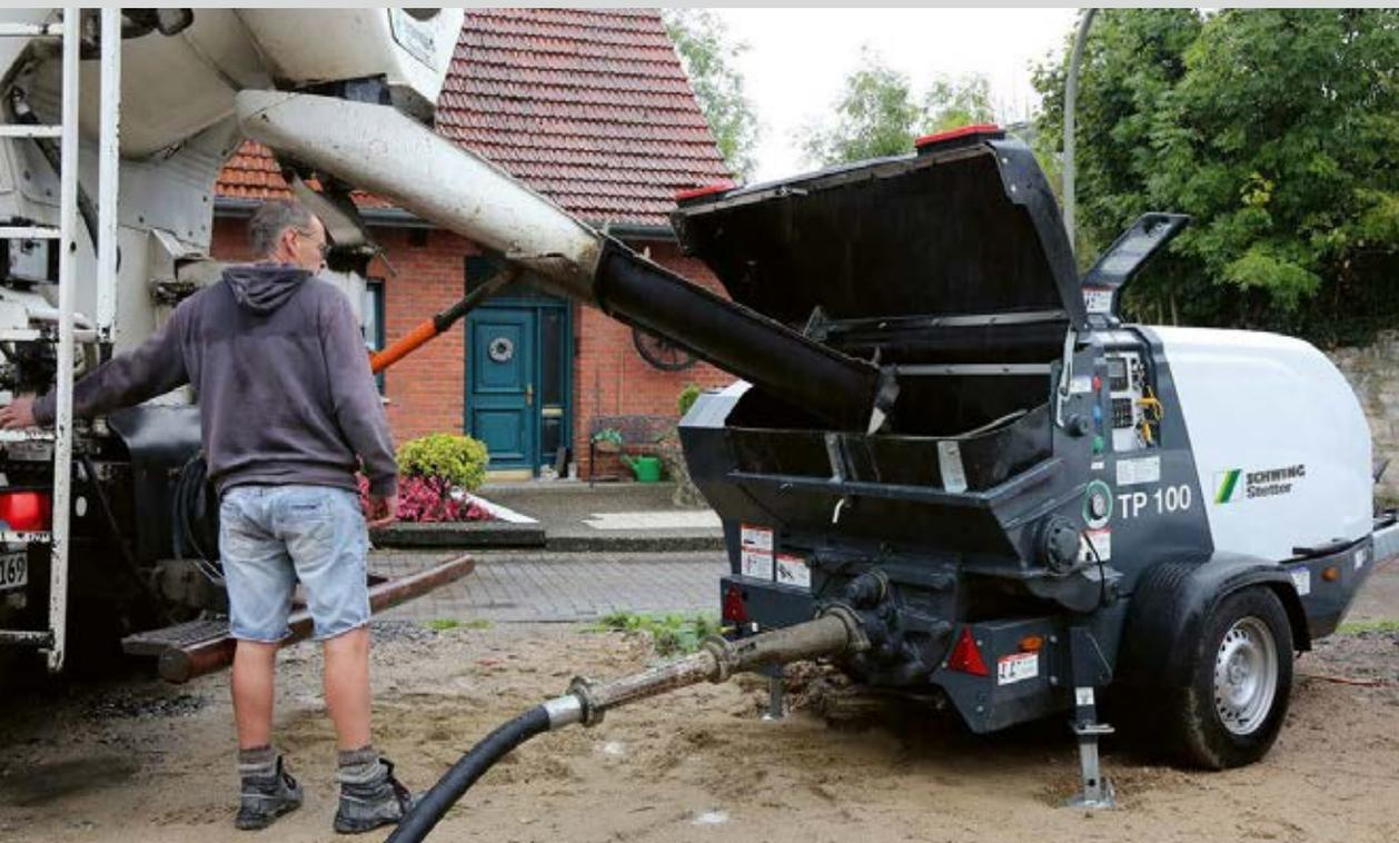
La haute capacité de pompage et l'encombrement compact, associés au poids de 2'100 kg maximal de la machine, ouvrent un vaste spectre d'utilisations à la TP 100.
