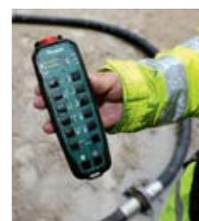
La TP 100 peut également être desservie à l'aide d'une commande à distance par radio.
