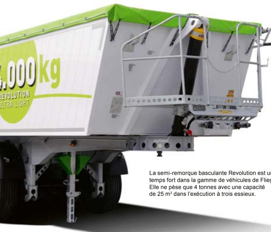
La semi-remorque basculante Revolution est un temps fort dans la gamme de véhicules de Fliegl. Elle ne pèse que 4 tonnes avec une capacité de 25 m<sup>3</sup> dans l'exécution à trois essieux.
