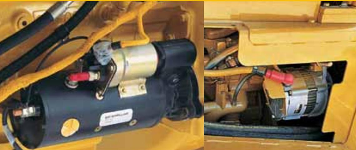
Cat® Anlasser und Alternatoren sind Teil eines ausbalancierten, elektrischen Systems und arbeiten in Einklang mit der gesamten Maschine. Sie sind genau auf das Drehmoment ihrer Cat eingestellt und sind so gebaut, dass sie auch in widerlichen Umständen ihre Maschine verlässlich aufstarten.
