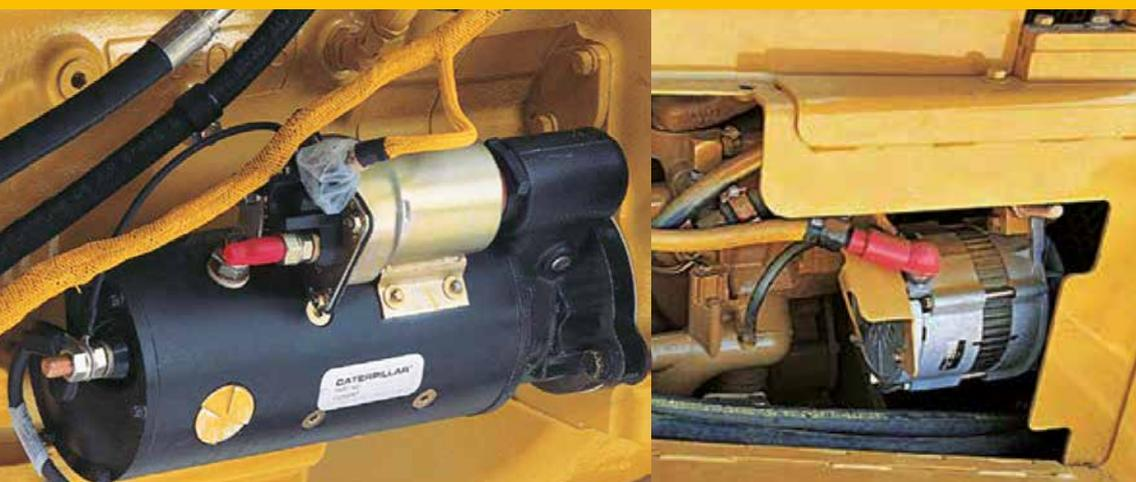
Les démarrateurs et alternateurs Cat® font partie d'un système électrique équilibré et travaillent en harmonie avec toute la machine. Ils sont exactement réglés sur le couple de votre Cat et sont conçus de sorte à pouvoir démarrer votre machine en toute fiabilité, même en présence de circonstances astreignantes.
