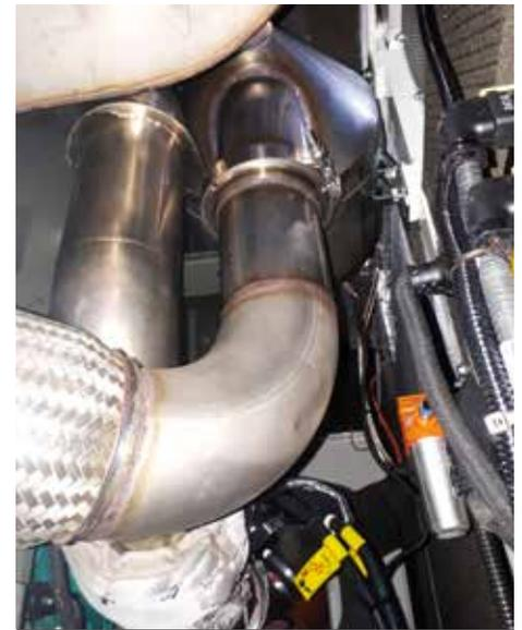
Sehr enge Platzverhältnisse. Einzel Oxi-KAT auf Klemm-Bohrgerät aufgebaut.
