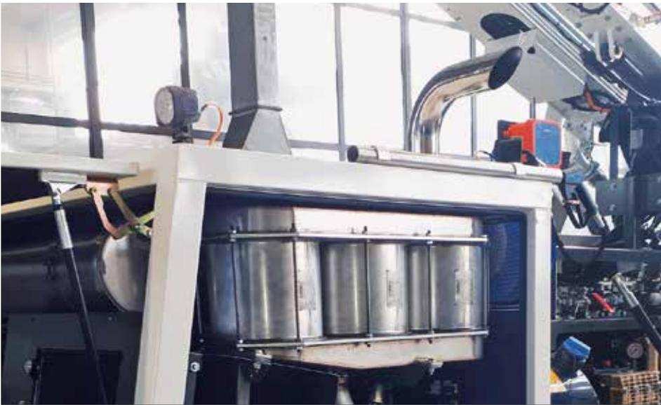
Dreifach 9" x 12" System, individuell gefertigt auf Klemm-Bohrgerät.
