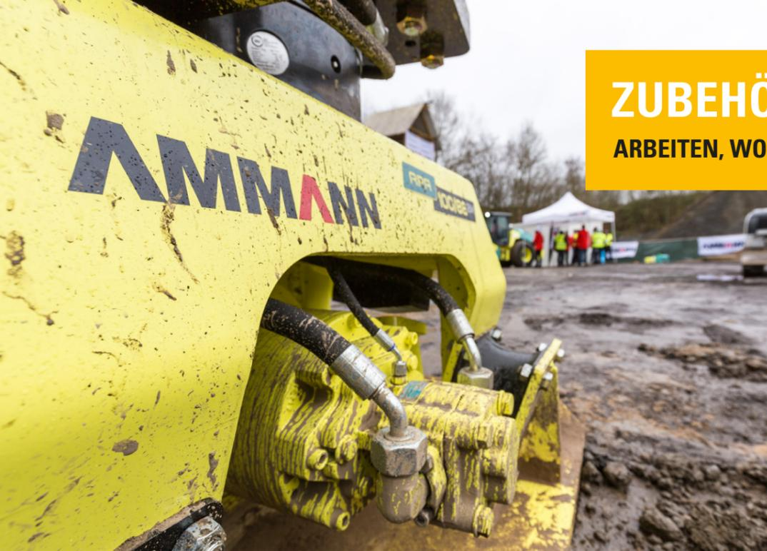
Arbeiten Sie in speziell anspruchsvollem Terrain? Mit den Anbauverdichtern von Ammann in Breiten von 30 bis 880 cm verdichten Sie Stellen, die mit herkömmlichen leichten Maschinen nicht zu erreichen sind. Durch die Schnellkupplungssysteme lassen sich die Geräte im Handumdrehen mit allen marktüblichen Trägergeräten verbinden.
