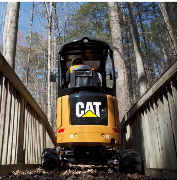
Les mini-pelles dans la catégorie de grandeur de 1 à 3 tonnes sont utilisées pour les travaux de fouille et de levage sur le chantier et, grâce à leur encombrement compact, passent pratiquement à travers toutes les portes de jardins. Tout en douceur, de façon modérée ou rapide: La réactivité de l'hydraulique s'adapte parfaitement et de manière toute simple via moniteur aux besoins du machiniste.
