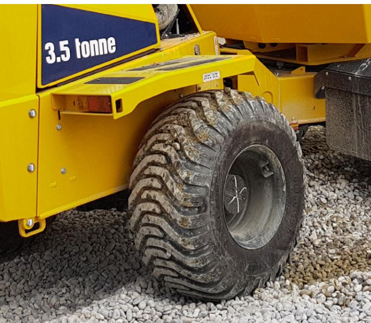
Les tombereaux sur pneus sont des multi-talents pour le transport des matériaux. Un déplacement qui ménage le sol est particulièrement important dans l'horticulture et l'aménagement des paysages, ce que les modèles sélectionnés de tombereaux sur pneus Thwaites réalisent, grâce à leurs largeurs des pneus de 400 et 500 mm, ce qui permet de conduire avec des pressions de pneus réduites.
