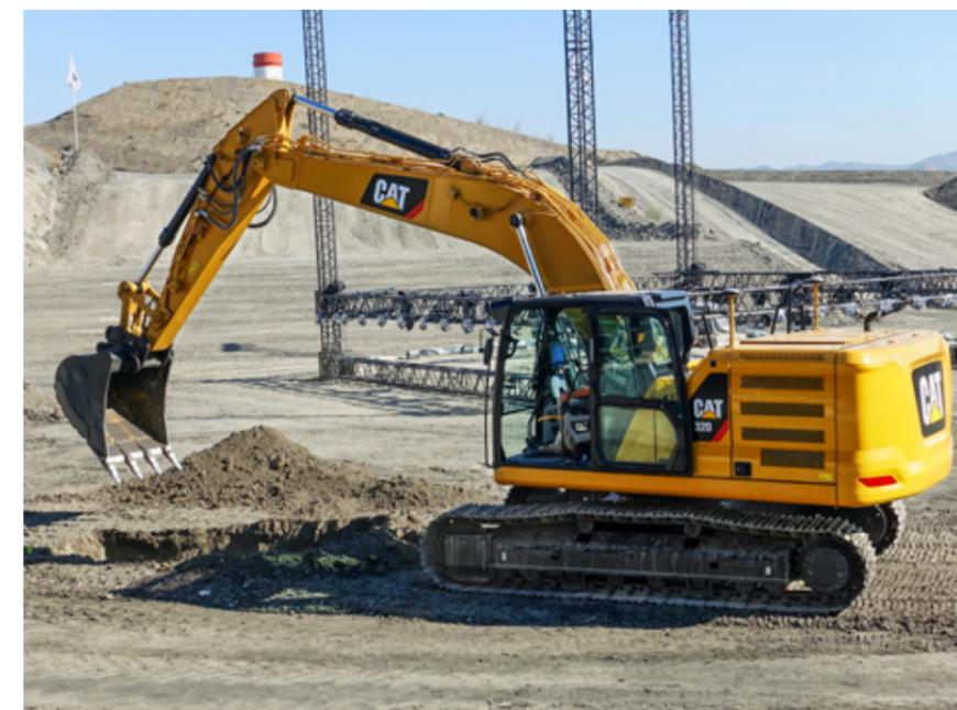
Die Systemfunktion «E-Fence» ermöglicht beim Cat 320 die Begrenzung des Schwenkbereichs. Der Maschinist kann den Schwenkradius festlegen, bei dem der Baggerarm automatisch gestoppt wird.
