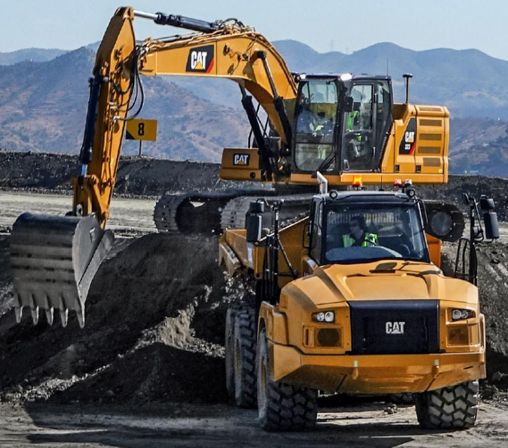
Der Cat 323 im Einsatz: Bei der Beladung wird automatisch mit dem Wägesystem «Cat Payload» das Gewicht jeder einzelnen Schaufelfüllung registriert, das Gesamtgewicht berechnet und so die Überladung des Transporters vermieden.
