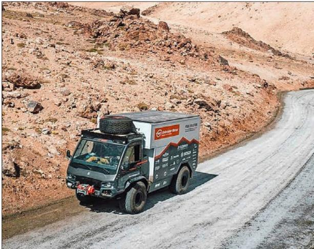
Angetrieben wird das Fahrzeug von zwei Elektromotoren mit je 120 kW. (Bild: facebook/terren)
