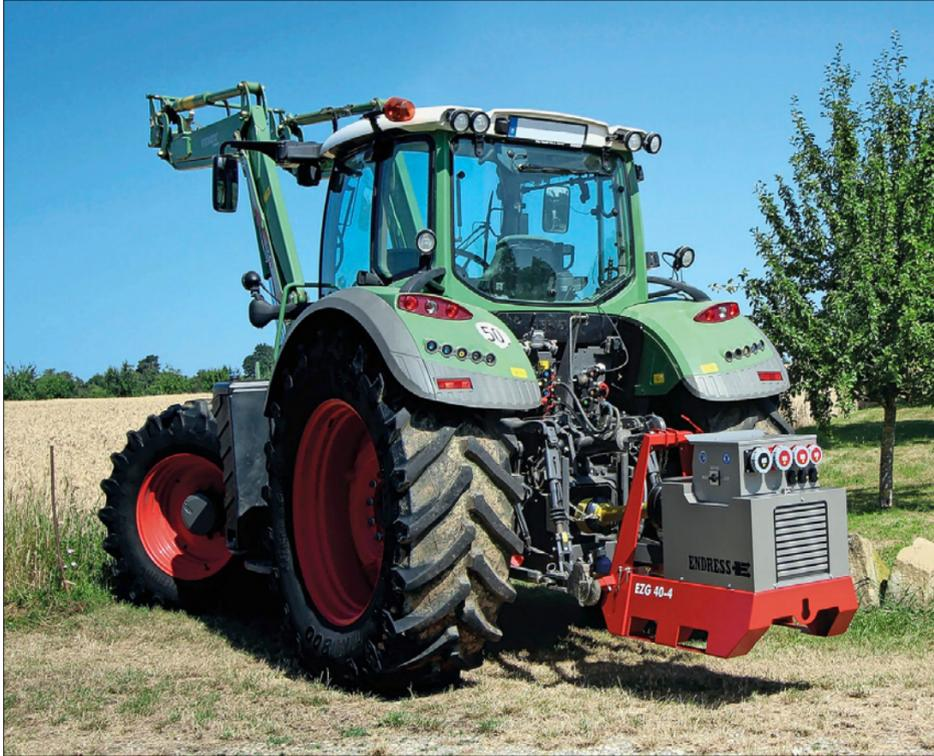
Der Zapfwellengenerator liefert Strom auch dort, wo kein Netz in der Nähe ist. (Bild: zvg)
