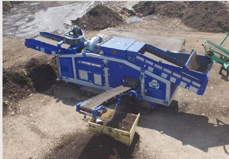
Edge MC1400: Aussortieren von Störstoffen in mehreren Prozessschritten.
