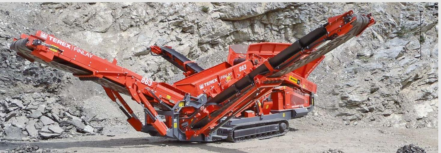
**8-er Serie:** Schwerlastsiebanlagen für die Absiebung von grobem Material.
