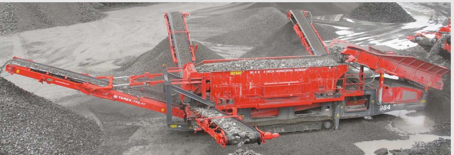
**9-er Serie:** Horizontale Siebanlage mit drei Decks für die Verarbeitung grosser Materialmengen im Steinbruch und für Recycling-Anwendungen. Ermöglicht das Absieben von vier Fraktionen.
