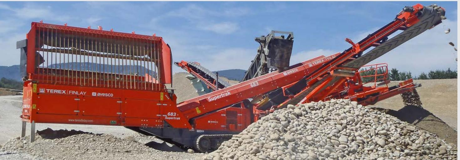
**6-er Serie:** Siebanlagen mit 2 oder 3 Siebdecks für die Herstellung von Endkomponenten.
