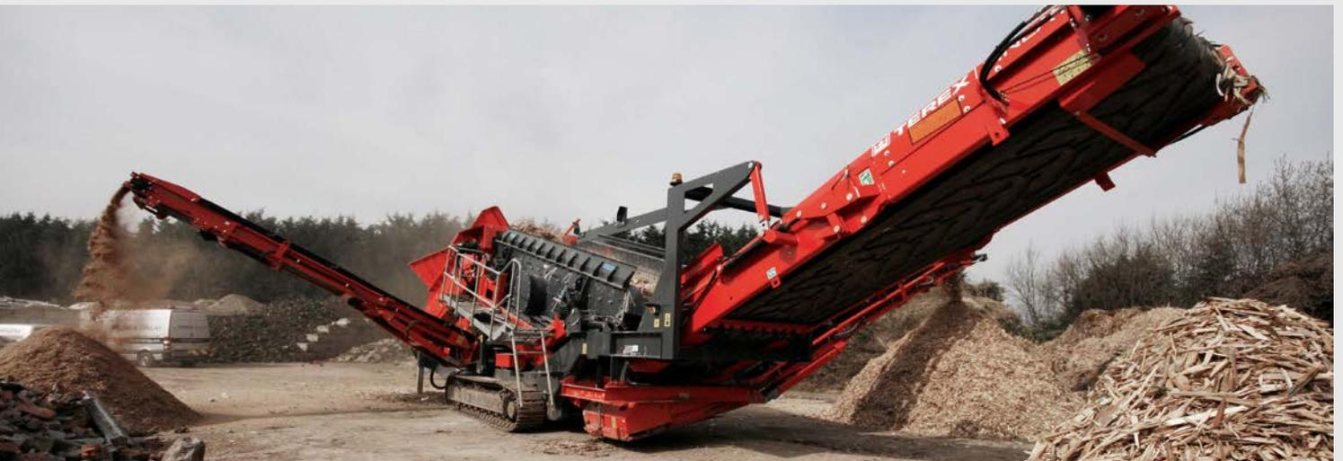
**883+:** Innerhalb der 8-er Serie die flexibelste Anlage und geeignet als Primär- oder Sekundärsieb. Die Spaleck mit Spannwellensiebmaschinen ist für die Absiebung von Feinfraktionen konstruiert.
