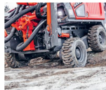
Allradantrieb und Oszillation gewährleisten perfekte Mobilität und Stabilität.
