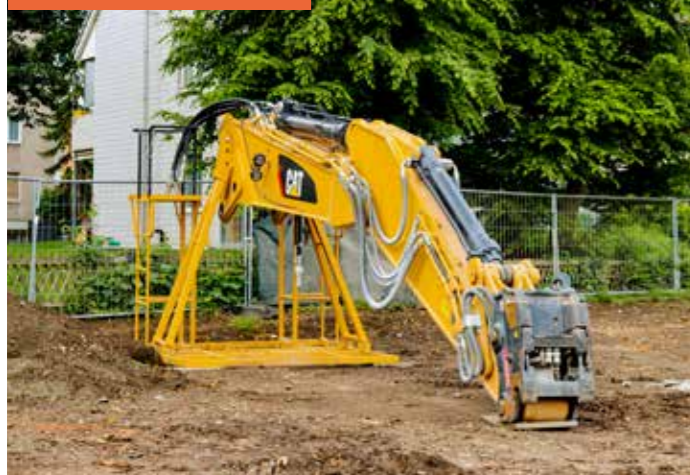
Für eine sichere Ablage und den gefahrenfreien, schnellen Wechsel der zwei Ausleger wurde von Avesco ein spezielles Transportgestell gefertigt.
