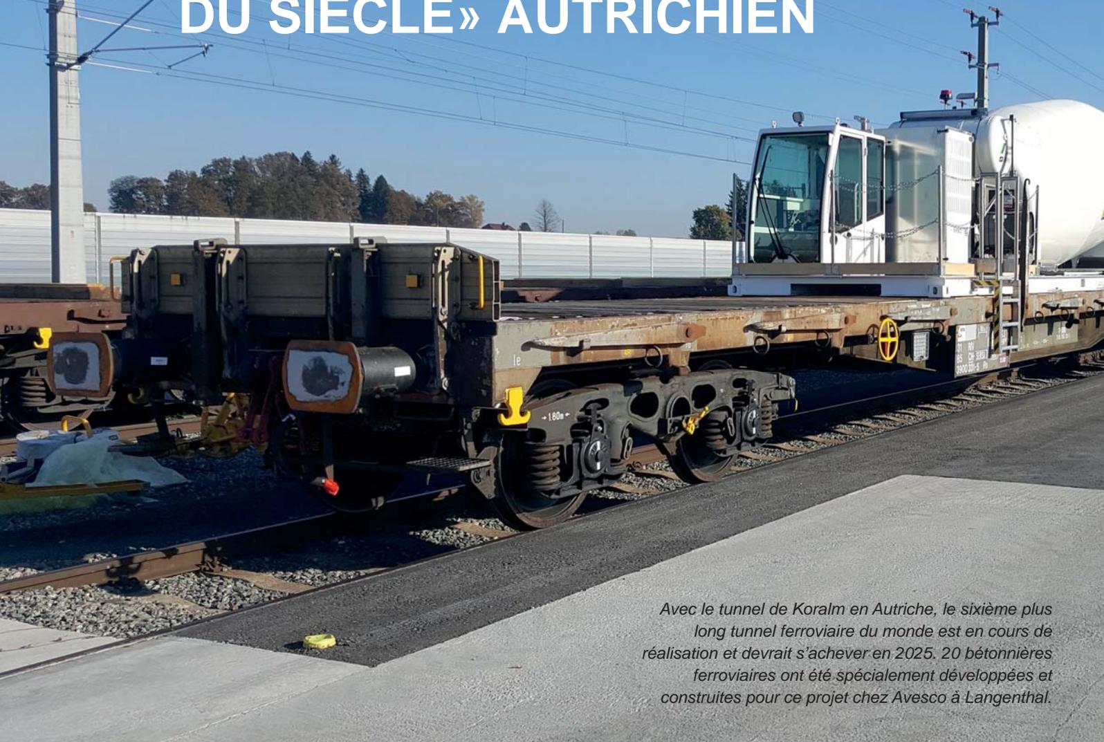
*Avec le tunnel de Koralm en Autriche, le sixième plus long tunnel ferroviaire du monde est en cours de réalisation et devrait s'achever en 2025. 20 bétonnières ferroviaires ont été spécialement développées et construites pour ce projet chez Avesco à Langenthal.*
