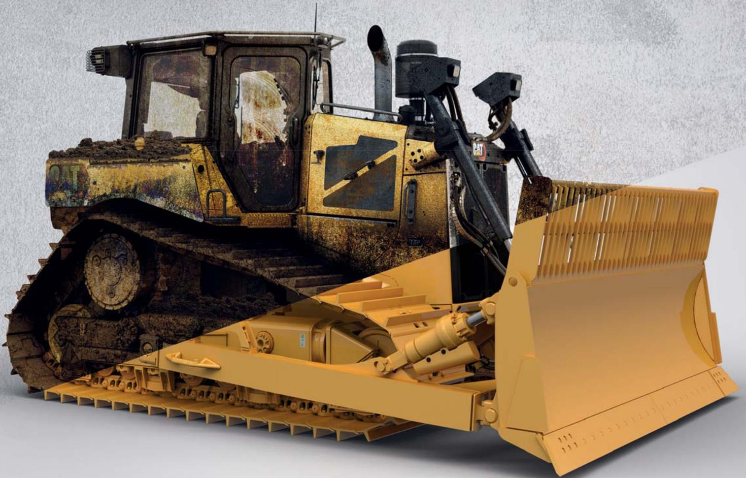
Cat® Certified Powertrain Rebuild est une révision générale qui remet votre machine de chantier dans son état neuf. Et ce, pour 30 à 60 % du prix de la machine neuve.
