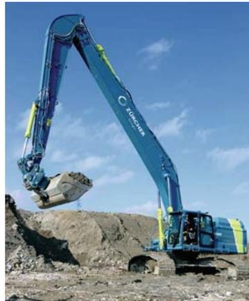
Sur le site, la Pelle hydraulique 352 LRE a été utilisée pour combler la zone avec des gravats, du béton et des sols provenant d'autres sites. Cette tâche est plus compliquée qu'elle ne paraît car la terre doit être consistante en plusieurs couches dont l'épaisseur doit être régulée et contrôlée. Cependant, le système GPS embarqué de la pelle hydraulique parvient à placer ces couches de façon à exécuter le travail très rapidement.
