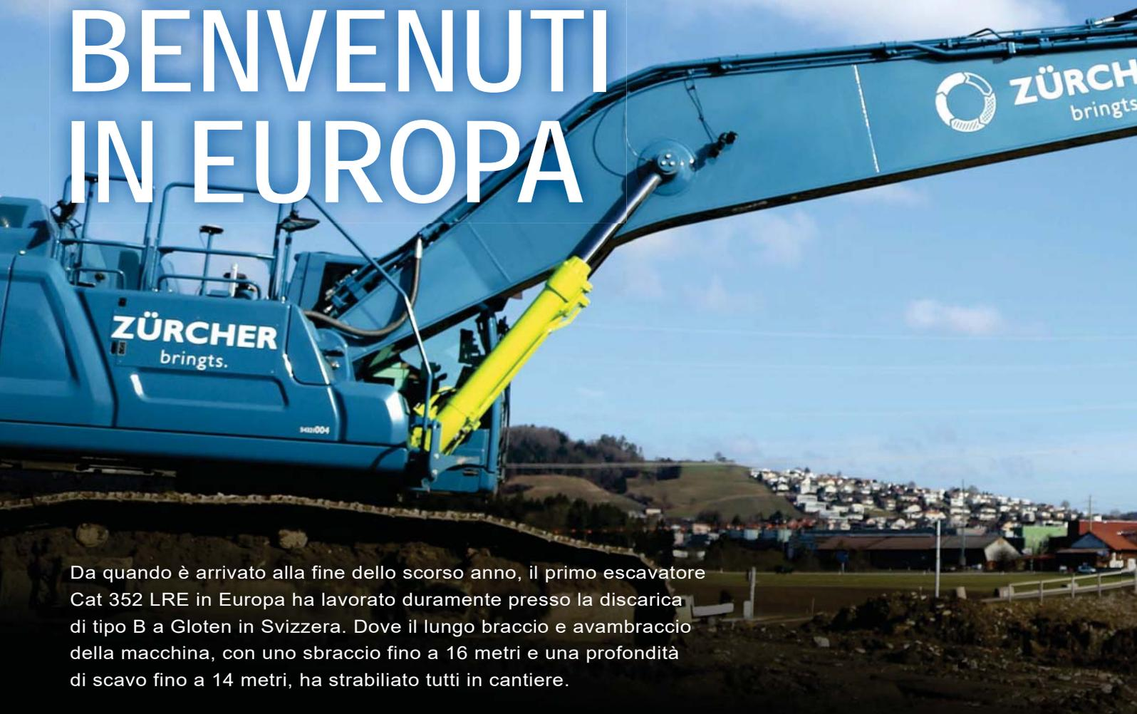
Da quando è arrivato alla fine dello scorso anno, il primo escavatore Cat 352 LRE in Europa ha lavorato duramente presso la discarica di tipo B a Gloten in Svizzera. Dove il lungo braccio e avambraccio della macchina, con uno sbraccio fino a 16 metri e una profondità di scavo fino a 14 metri, ha strabiliato tutti in cantiere.
