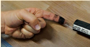
Schmutz im Hydraulikschlauch.
