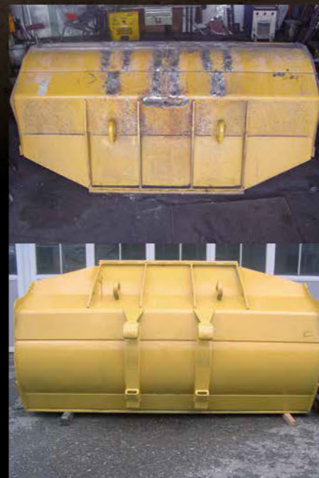
Umbauten von Kübeln
