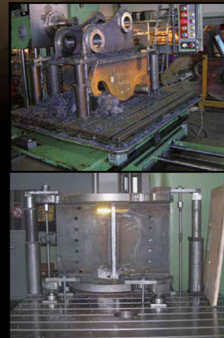
Bohrwerkarbeiten: Bohrungen aufschweißen und auf Mass ausbohren
