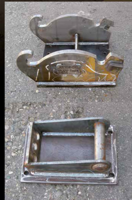
Anfertigen von Anbauplatten
