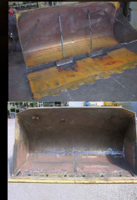
Kübelreparaturen und Kübelrevisionen
