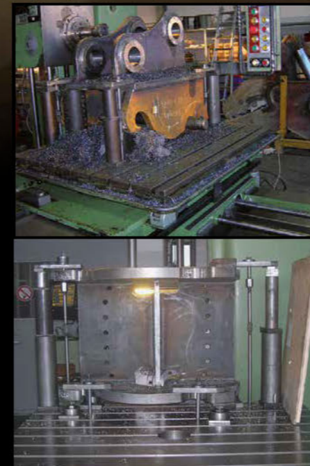
Travaux sur aléuseuse - fraiseuse: Rechargement de sièges de palier et alésage sur mesure
