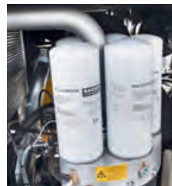
Die fünf Spin ON Filter können zu Wartungszwecken leicht herausgedreht werden.
