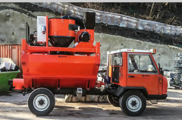
Auf den Transporter des österreichischen Herstellers REFORM, Modell Muli, wurde die Staubabsaugung von ILMEG aufgebaut.
