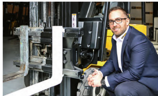
Thorsten Reigers de la division Manutention d'Avesco. Transformer l'ancien en «comme neuf»: La moitié droite du chariot d'occasion, ici représenté, a été remis à neuf pour le label de qualité Avesco Approved «Or», l'autre moitié étant dans son état original.
