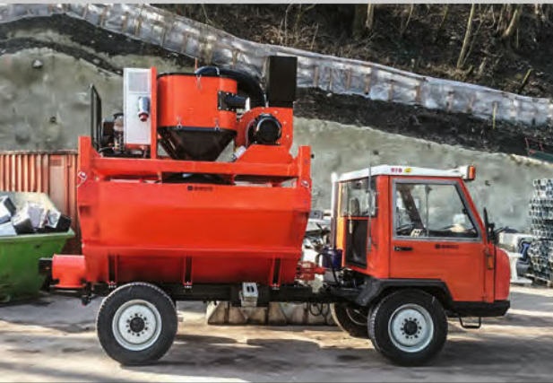
L'aspiration des poussières ILMEG a été montée sur le transporteur du fabricant autrichien REFORM, modèle Muli.
