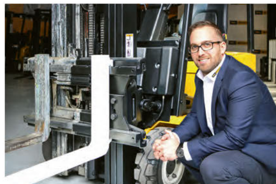
Thorsten Reigers del settore Avesco Logistica. Trasformare il vecchio in "quasi nuovo": la metà a destra del carrello d'occasione nella foto è stata rimessa a nuovo per il marchio di qualità Avesco Approved "Oro", l'altra metà è ancora nello stato originale.
