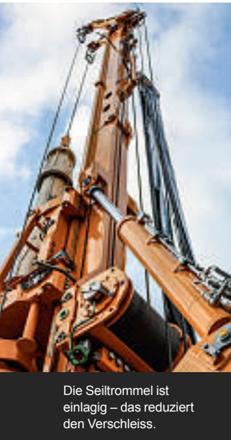
Die Seiltrommel ist einlagig – das reduziert den Verschleiss.
