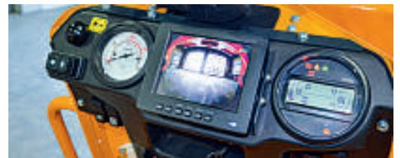
Das Armaturenbrett der neuen Dumper zeigt detailliertere Informationen an, warnt den Fahrer bei Maschinenfehlern und bietet einen 7 Zoll Farbmonitor für die Frontkamera.
