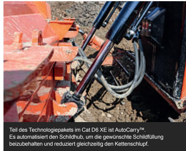
Teil des Technologiepakets im Cat D6 XE ist AutoCarry™. Es automatisiert den Schildhub, um die gewünschte Schildfüllung beizubehalten und reduziert gleichzeitig den Kettenschlupf.
