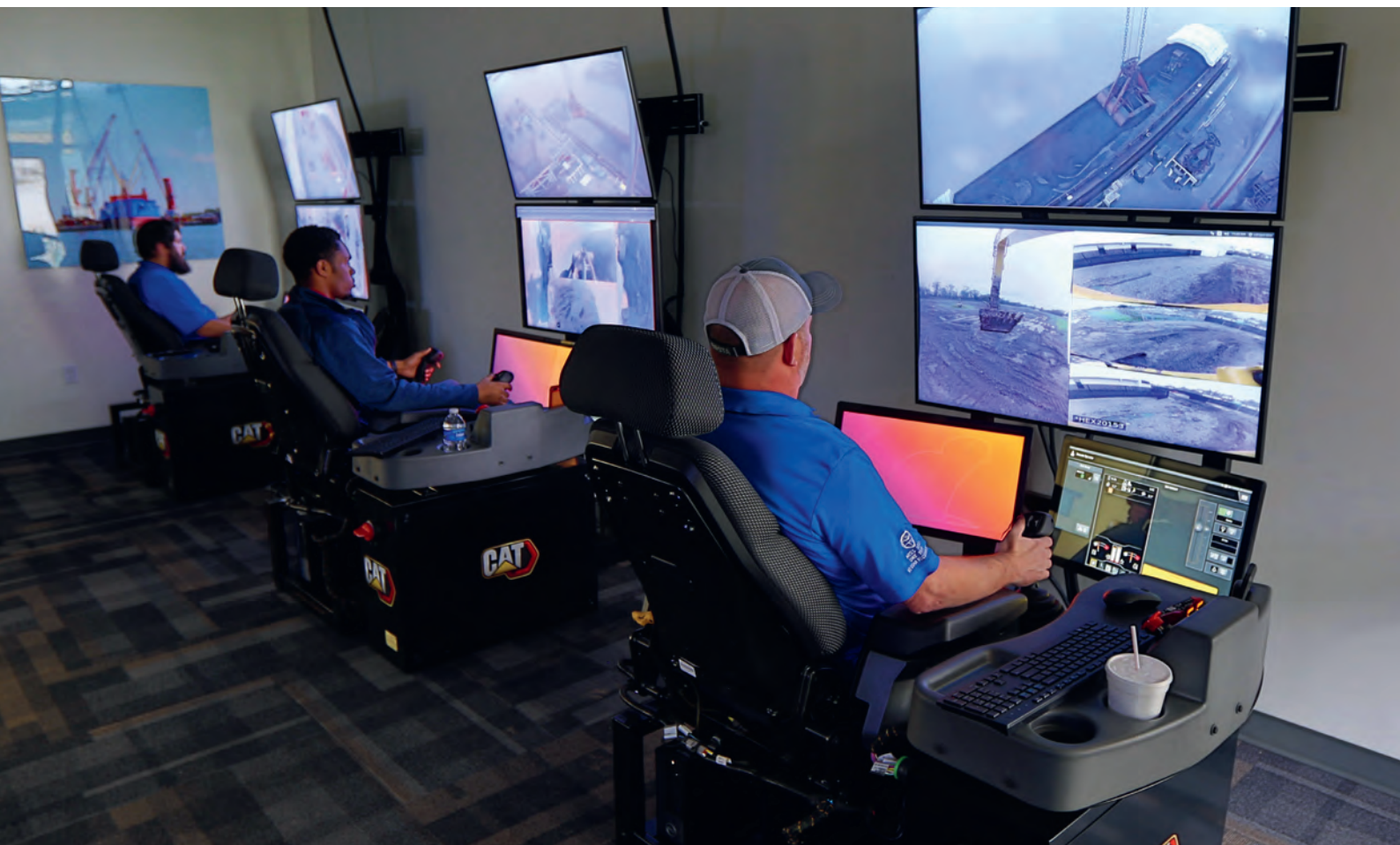
Aux Etats-Unis, Cat Command est utilisée, par exemple, dans les décharges avec des conditions de sol instables. Le machiniste commande la pelle depuis la console dans un bâtiment.
